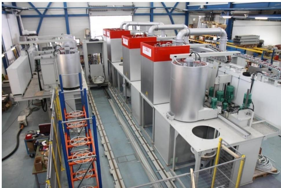
Slika 4. Peć za kaljenje [1]
