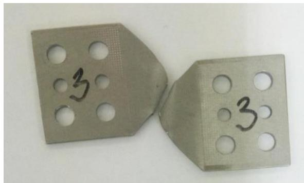
**Slika 6.14. Deformirani ispitni uzorak debljine 3 mm [16]**
