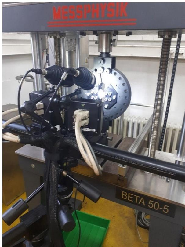
**Slika 5.5. Postavljanje optičkog sustava za ispitivanje**
