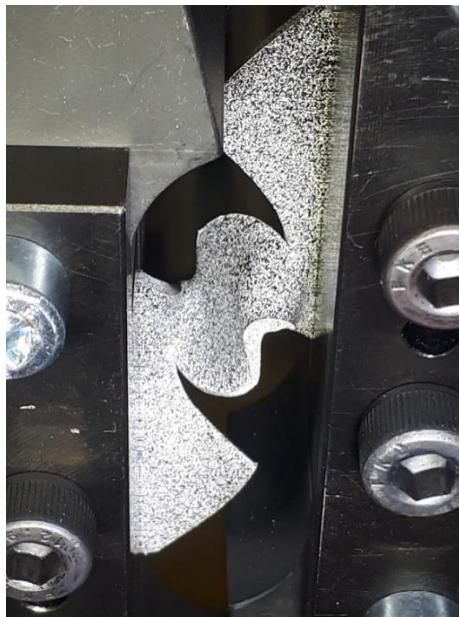
Slika 6.10. Deformirani ispitni uzorak debљine 2 mm
