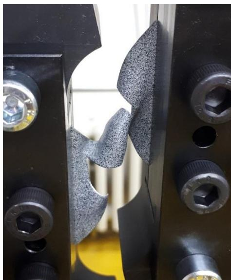
**Slika 6.6. Deformirani ispitni uzorak debljine 1 mm**
