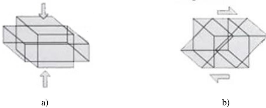
**Slika 2.4. Primjer: a) čistog i b) jednostavnog smika [6]**
