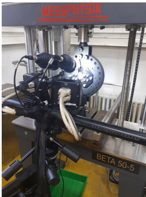
Slika 5.5. Postavljanje optičkog sustava za ispitivanje
