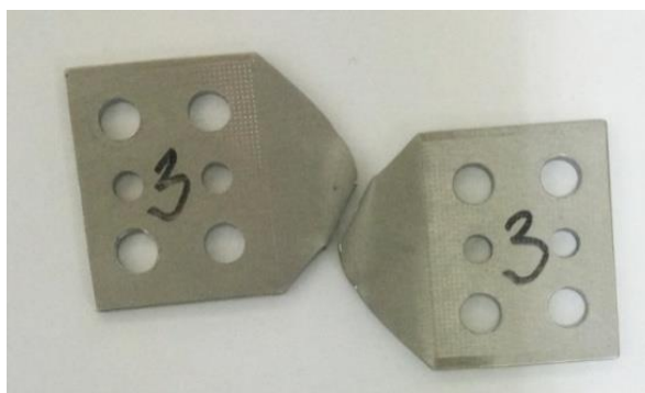
Slika 6.14. Deformirani uspitni uzorak debljine 3 mm [16]
