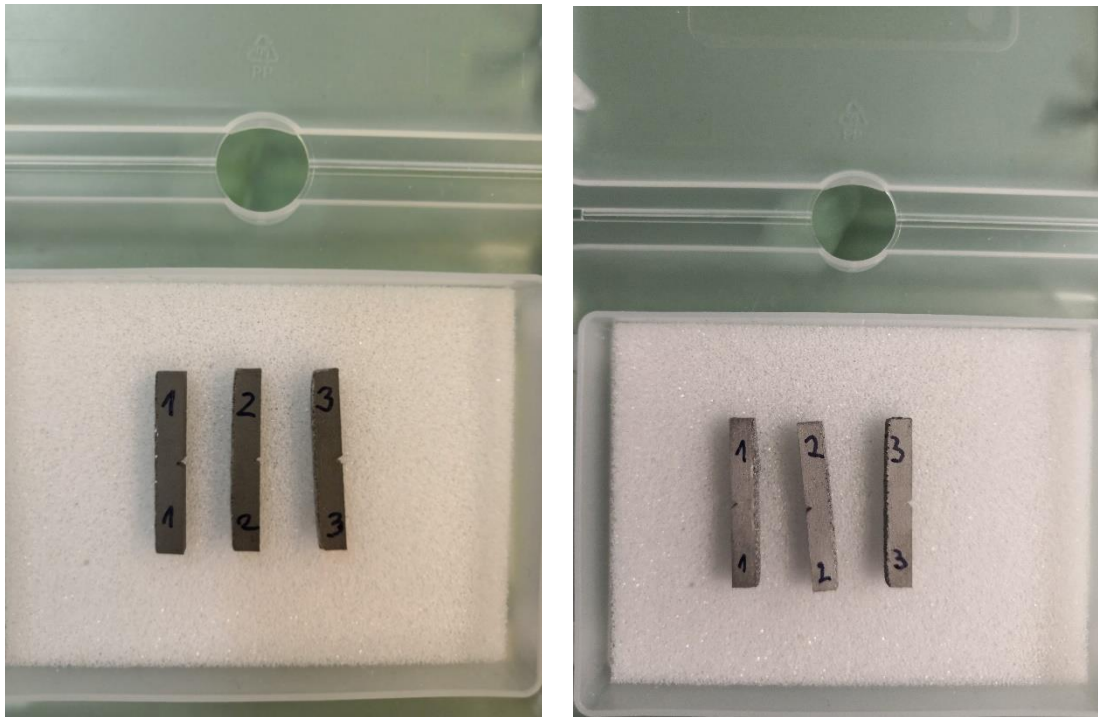
Slika 42. Isprintane epruvete za ispitivanje udarnog rada loma:
