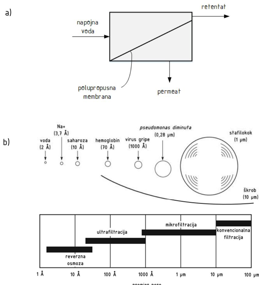
Slika 3: a) Principijelna shema filtracije pomoću membrane;
