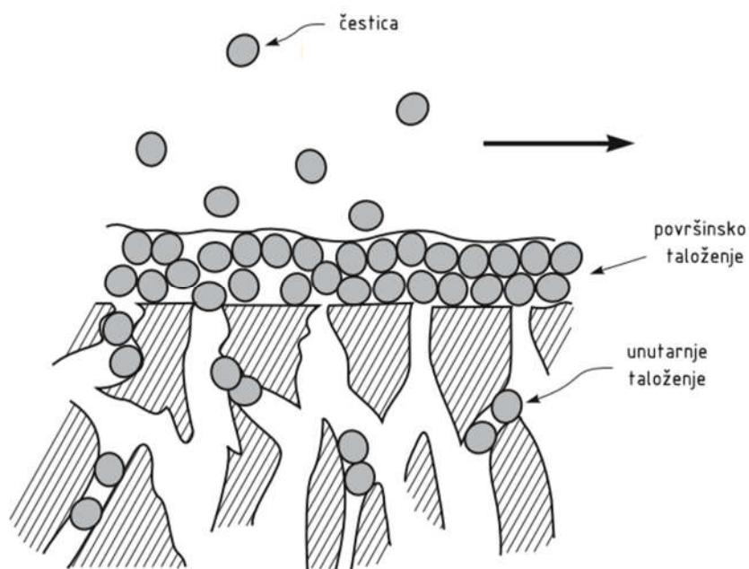
**Slika 6:** Prikaz taloženja na površini membrane te unutarnjeg taloženja [9]
