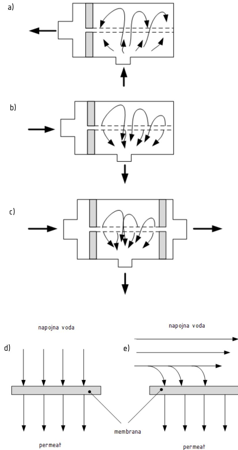
**Slika 9:** Prikaz strujanja unutar modula: a) princip izvana-unutra, b) jednoizlazni princip iznutra-van, c) ukriženi princip iznutra-van; prikaz strujanja u odnosu na mebranu: d) jednoizlazno, e) ukriženo [10]
