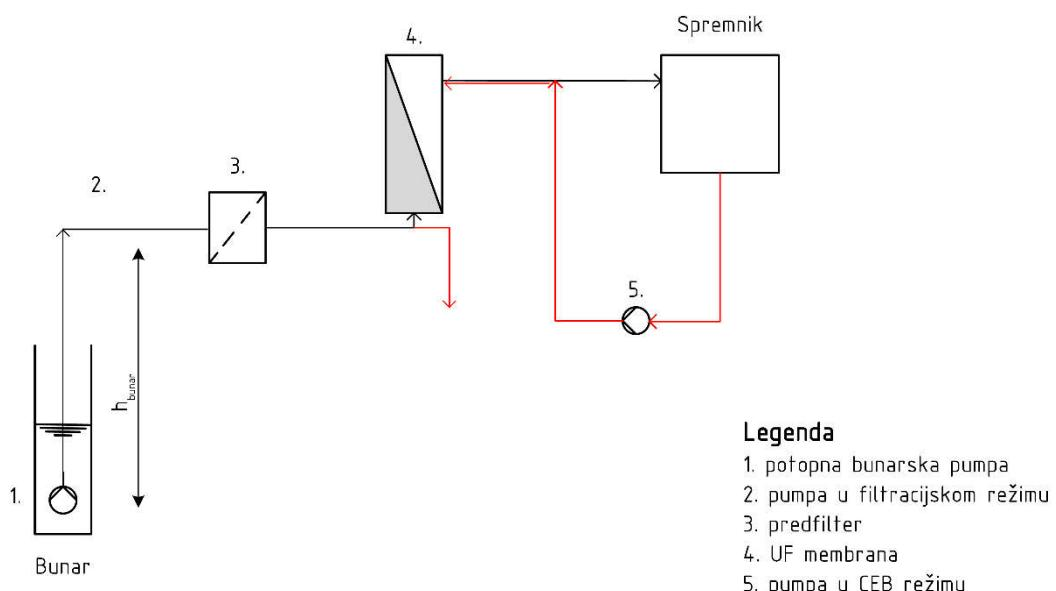
**Slika 15:** Principijelna shema značajnih padova tlaka u sustavu zanemareni u odnosu na one lokalnog karaktera.
