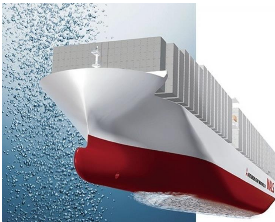
Slika 13. Skica sustava zračnog podmazivanja
