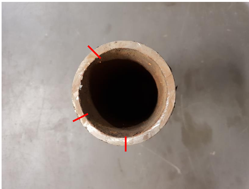
Slika 10. Prikaz stijenke i oblika stare cijevi
