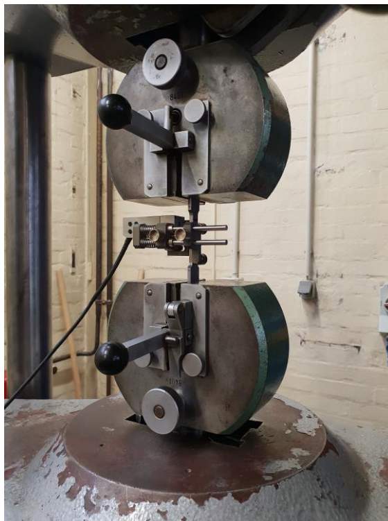
Slika 15. Prihvat ispitnog uzorka pri statičkom vlačnom ispitivanju
