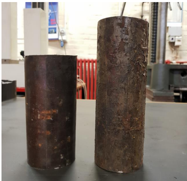
Slika 8. Nova i stara crpna cijev
