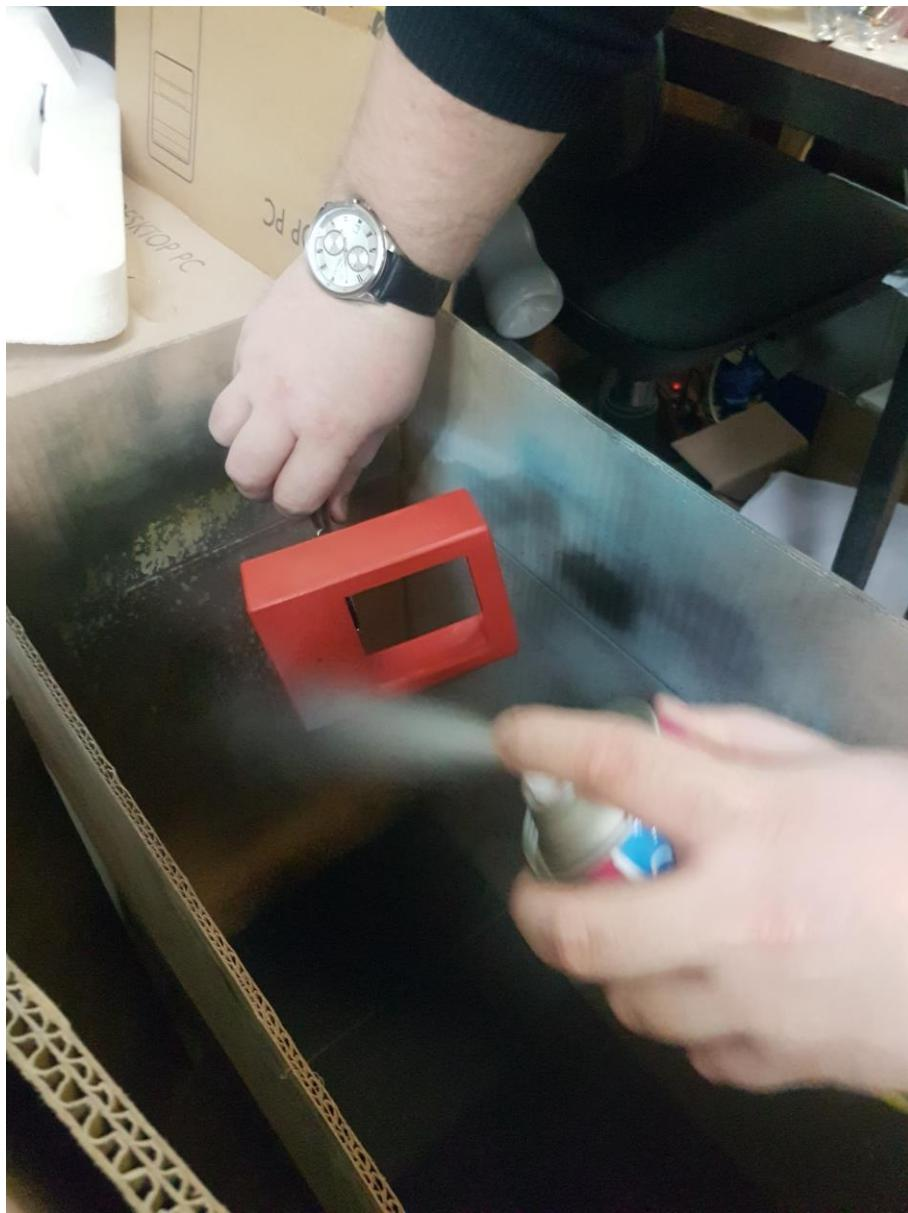
**Slika 29.** Prikaz postupka obrade akrilnim kitom kućišta QrBox-a
