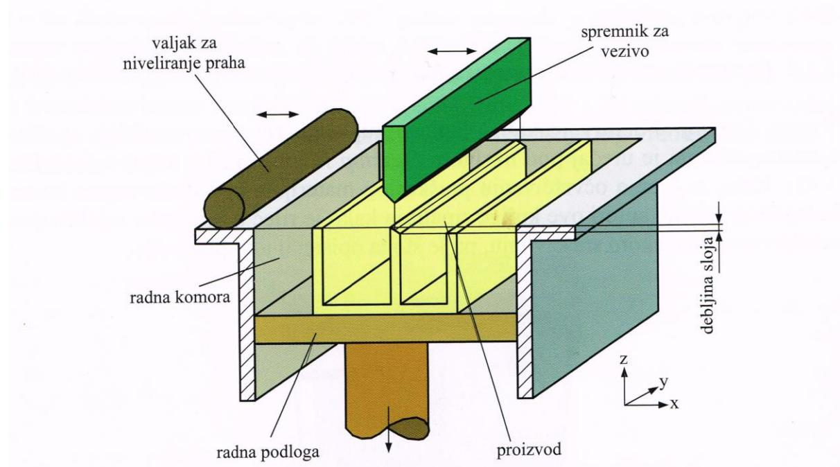
Slika 8. Načela rada postupka 3D tiskanja [1]
