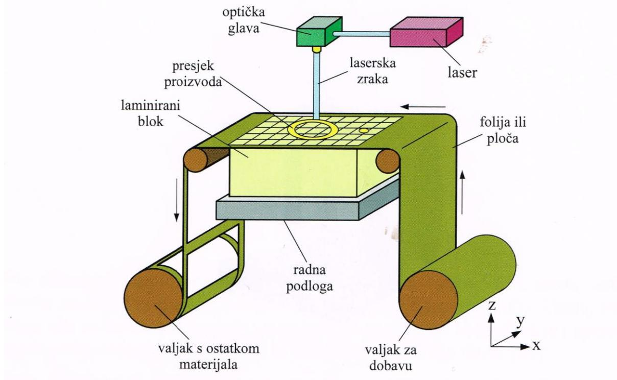
**Slika 9.** Načela rada postupka laminiranja [1]
