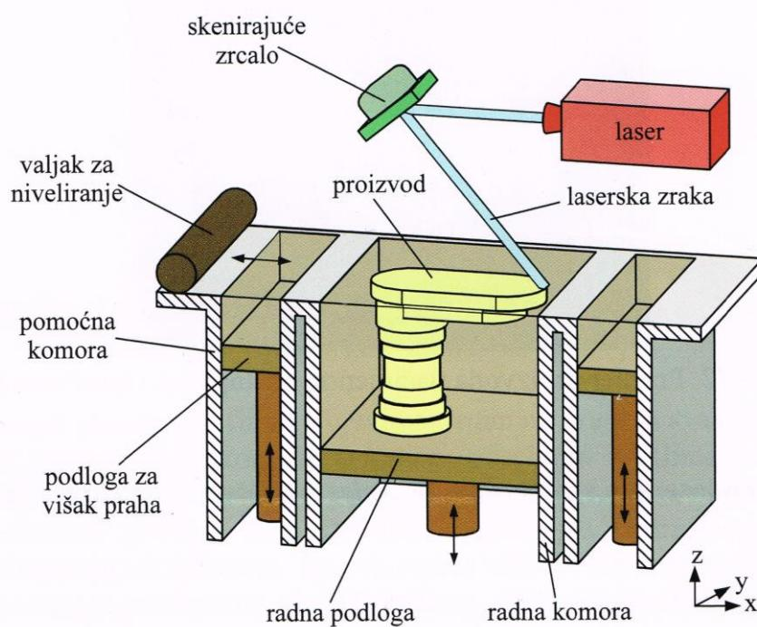
**Slika 7.** Načela postupka selektivnog laserskog srašćivanja [1]
