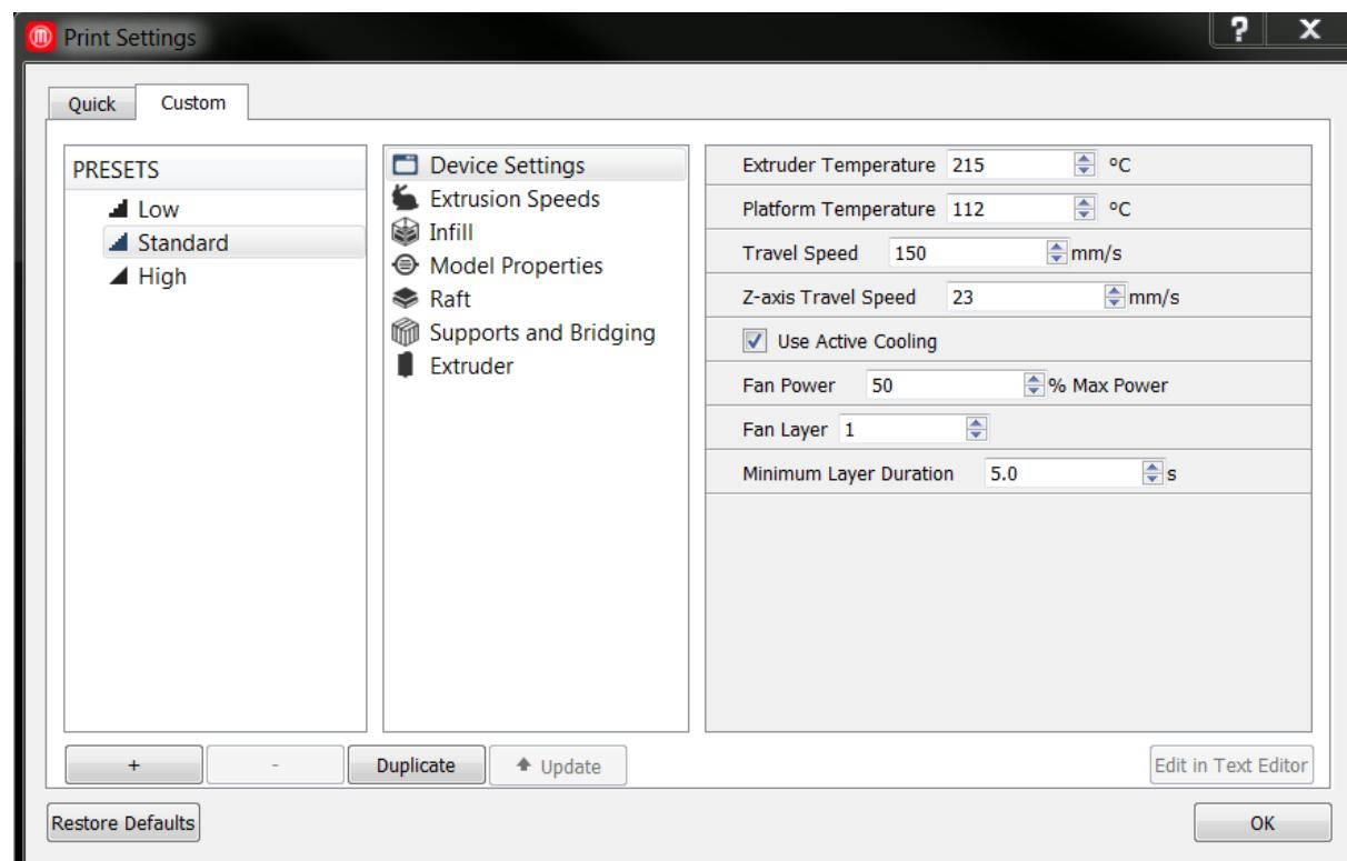
**Slika 24.** Određivanje nekih parametara unutar MakerBot MakeWare programa [7]
