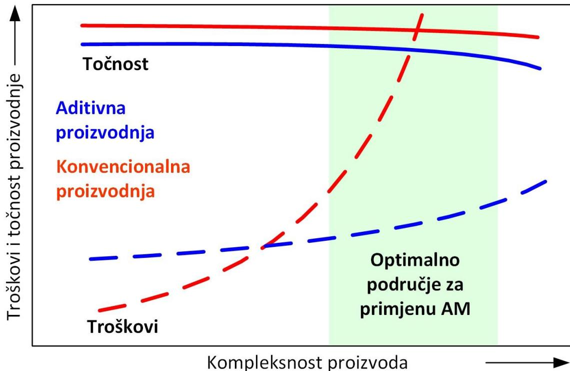
**Slika 4. Grafički prikaz opravdanosti primjene postupaka aditivne proizvodnje [1]**
