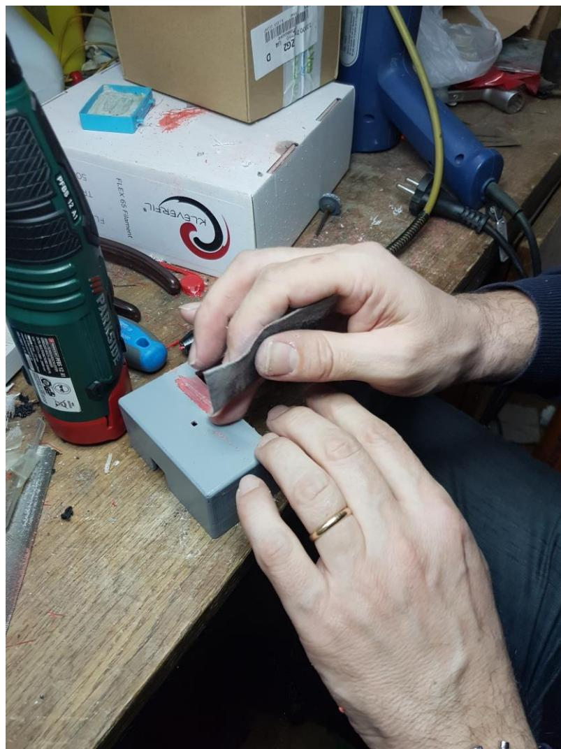
Slika 28. Prikaz postupka brušenja kućišta QrBox-a
