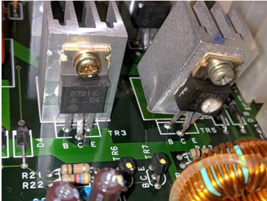
Slika 10. Lijevo ispravan tranzistor, desno neispravan [1]
