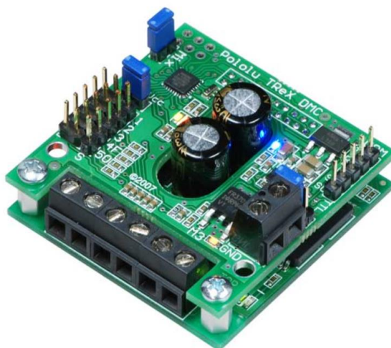
Slika 2. TReX kontroler DC motora marke Pololulu
