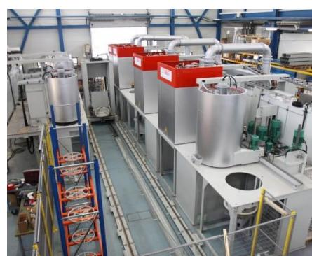
Slika 19. Peći za kaljenje[17]
