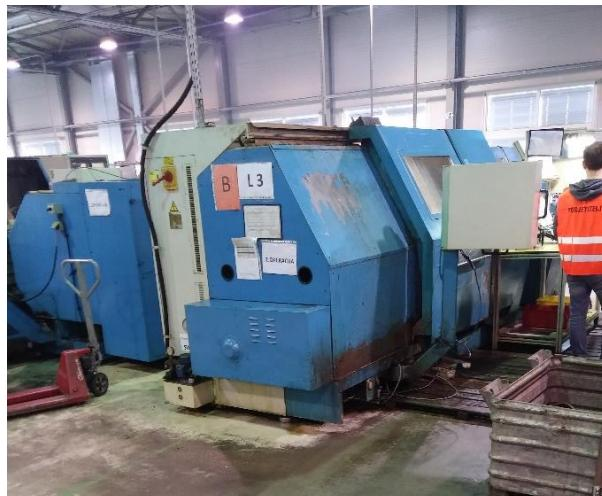
**Slika 5.15. Stroj bez andon sustava**
