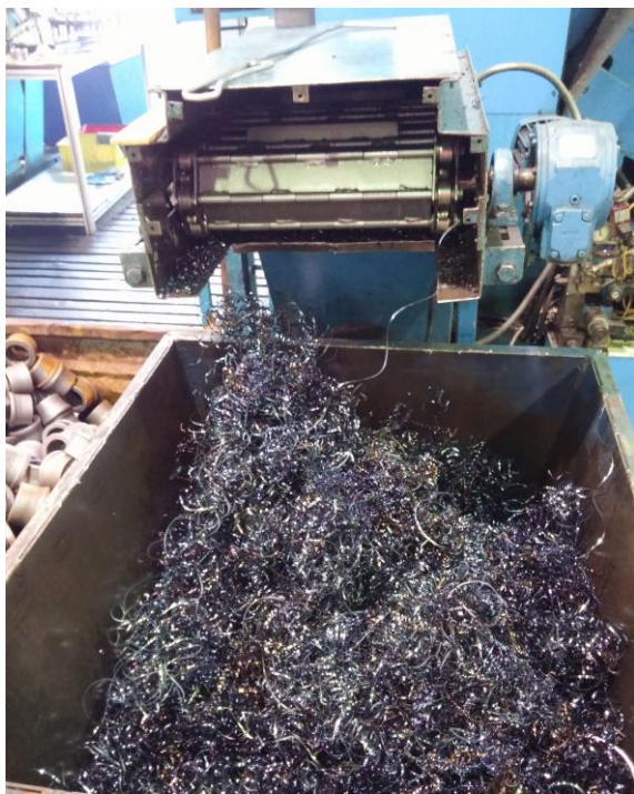
Slika 5.14. Ulazak odvojene čestice ispod konvejera
