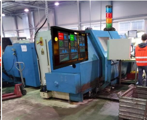
**Slika 5.16. Stroj s modernim andon sustavom**
