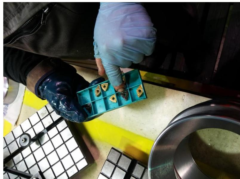
Slika 5.9. Zamjenske pločice
