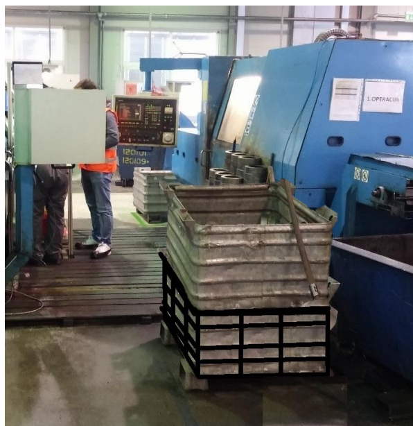
Slika 5.18. Preporučena visina spremnika za lakše izuzimanje otkivka
