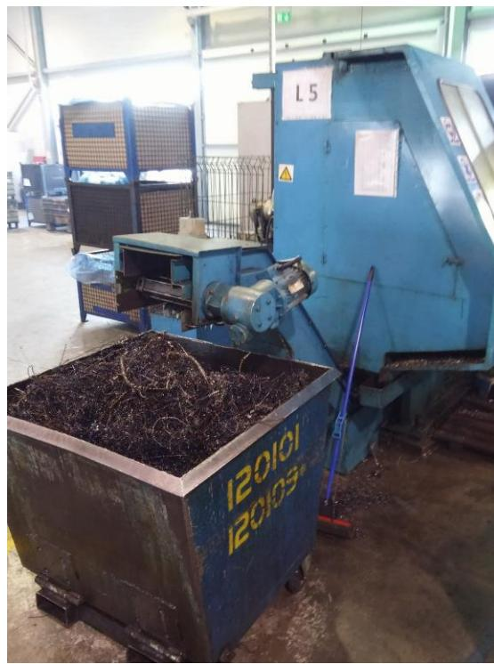
**Slika 5.5. Sustav za odvođenje odvojenih čestica iz stroja**
