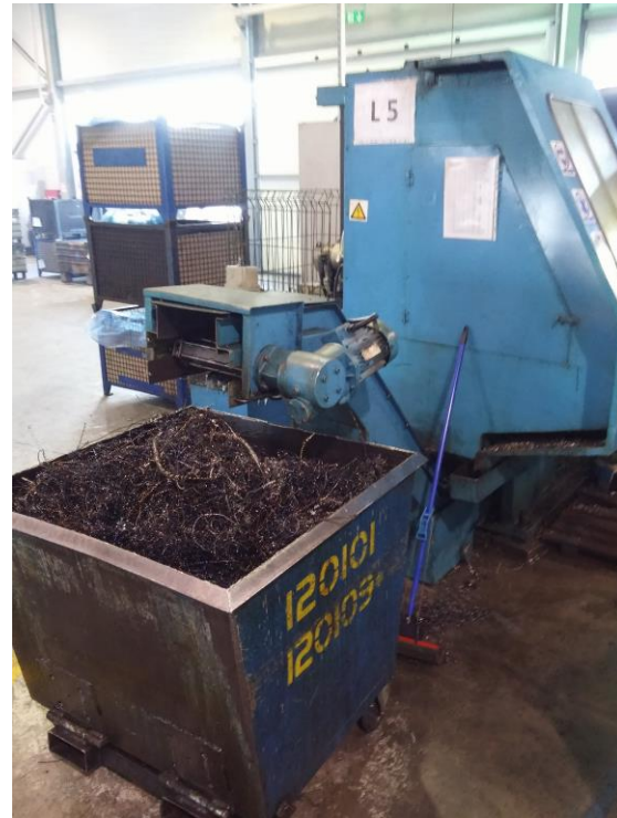
Slika 5.5. Sustav za odvođenje odvojenih čestica iz stroja
