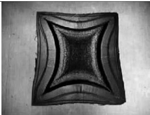
Slika 9. Uzdužno i poprečno utiskivanje jezgre [2]
