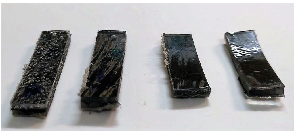
Slika 5.6. Ispitna tijela kompozitnih ploča za određivanje prividne međuslojne čvrstoće.
