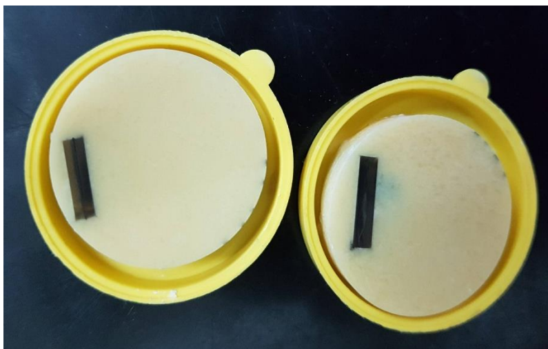
Slika 5.2. Pripremi zaliveni u kalupu u polimernoj masi.
