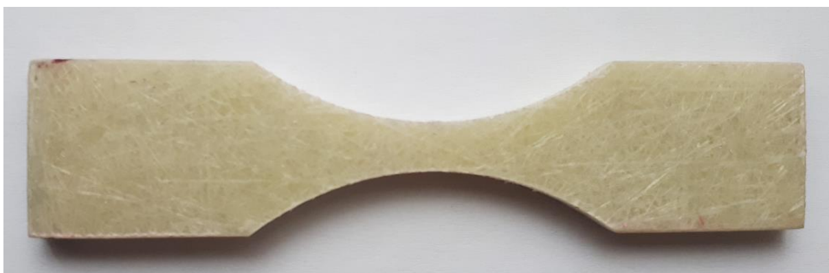
Slika 23. Uzorak za vlačno ispitivanje.
