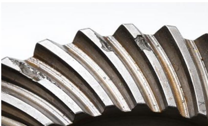
Slika 4. Oštećenje zuba stranim tijelom u zahvatu [5]
