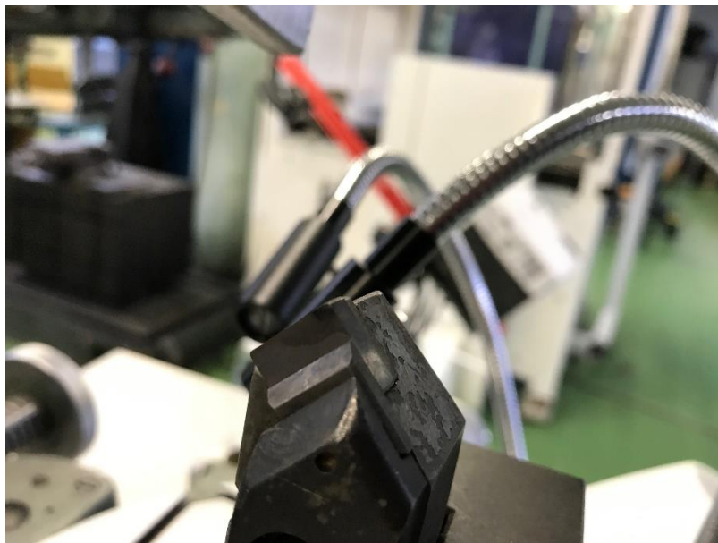
Slika 44. Rezna pločica pričvršćena u držaču
