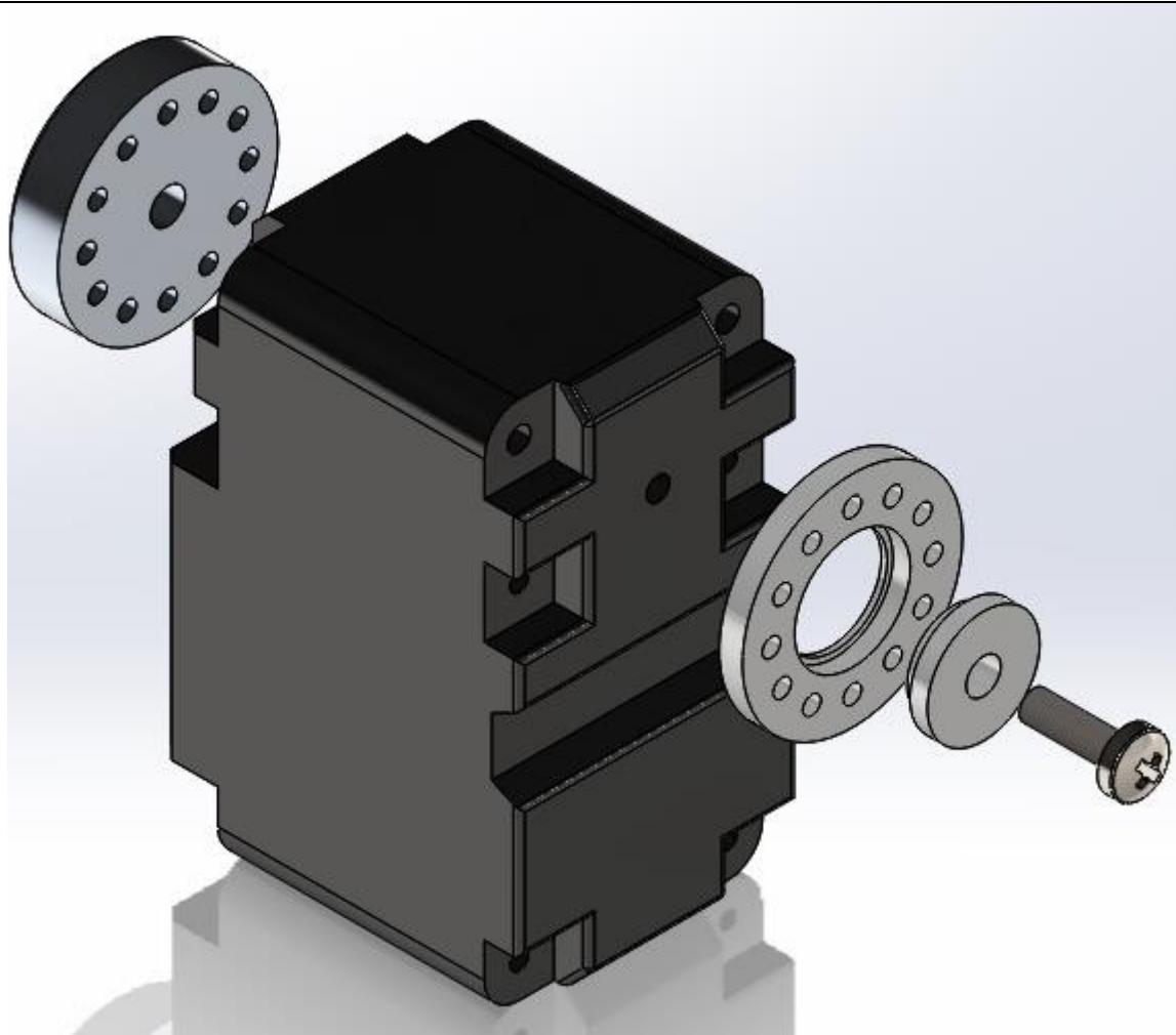
Slika 9. Sklop motora Herkulex DRS-0201
