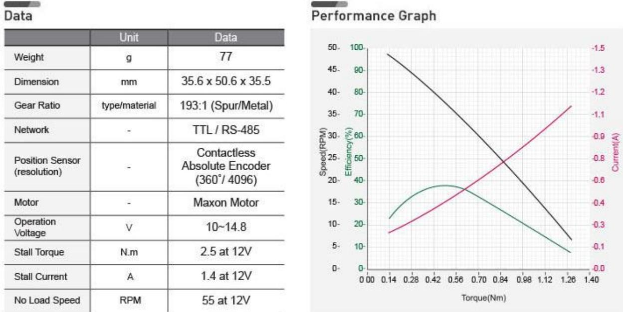
Slika 2. Karakteristike motora Dynamixel MT-28AT
