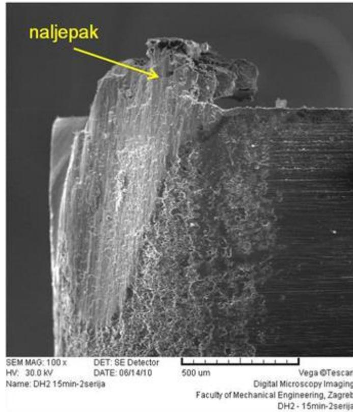
**Slika 35. Naljepak na oštrici alata [3]**
