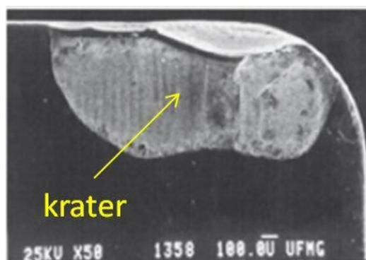
Slika 32. Pojava kratera na prednjoj površini rezne pločice [3]
