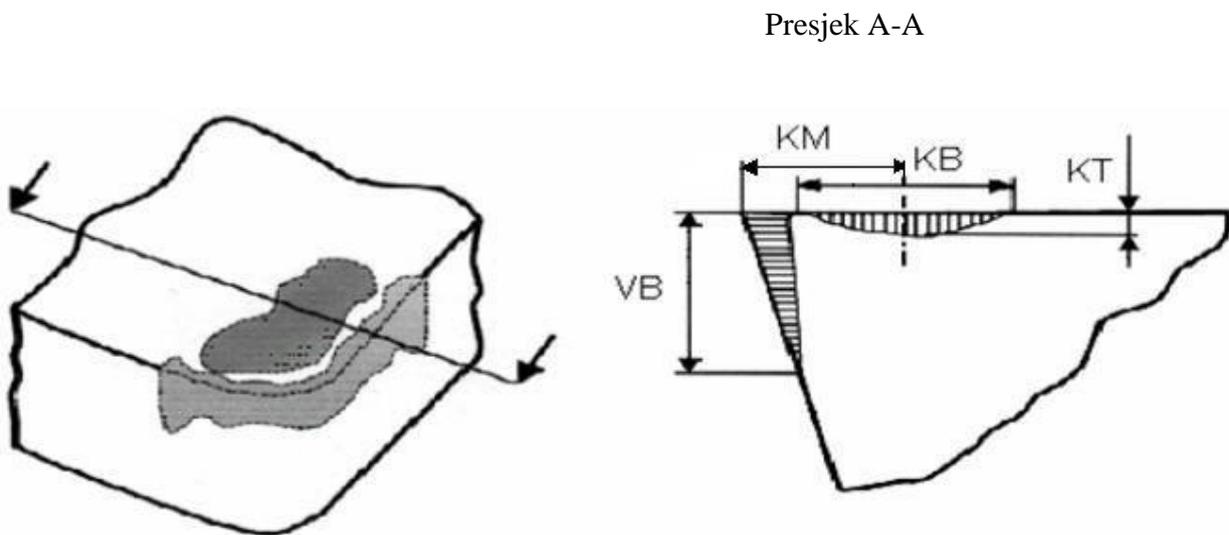
Slika 20. Karakteristični parametri trošenja rezne oštrice [3]
