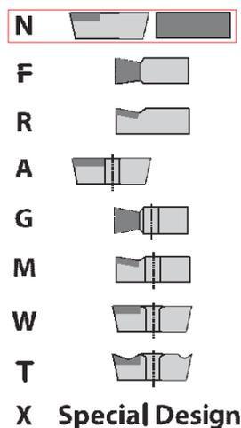
**Slika 31. Tipovi umetanja reznih pločica [10]**
