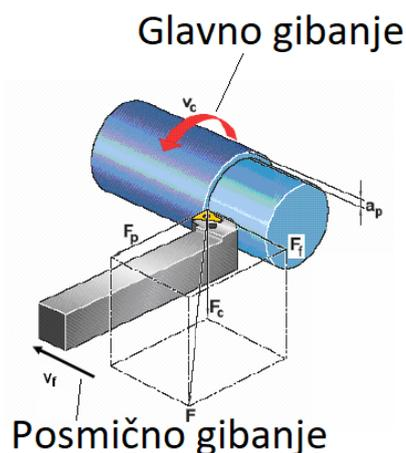
Slika 26. Gibanja kod tokarenja i parametri obrade [8]
