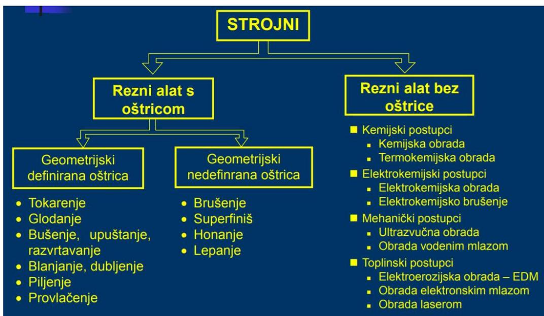
Slika 24. Podjela strojnih postupaka obrade odvajanjem čestica [8]
