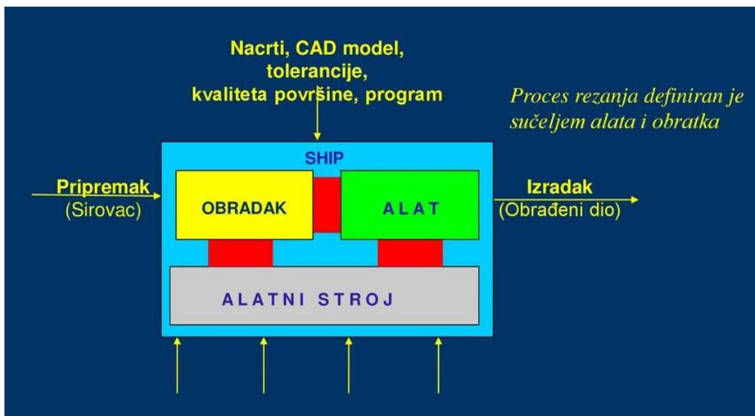
Slika 21. Shematski prikaz obrade odvajanjem čestica [8]
