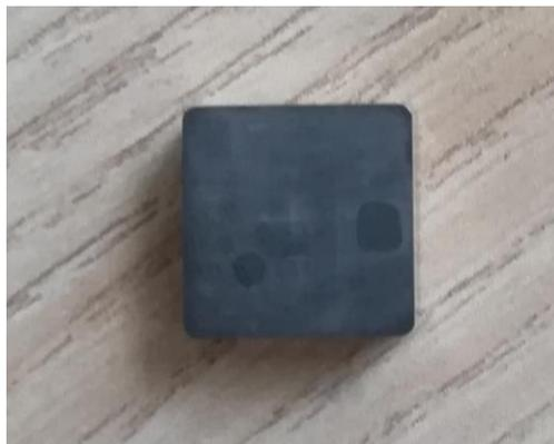
**Slika 36. Rezna pločica SNUN 120408**
