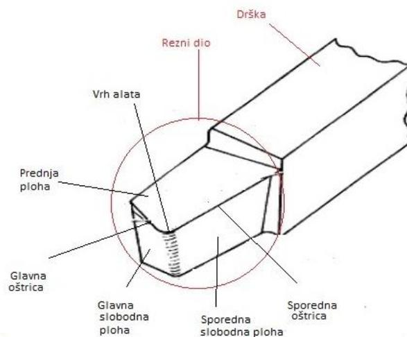
**Slika 22. Rezna oštrica s glavnim komponentama**
