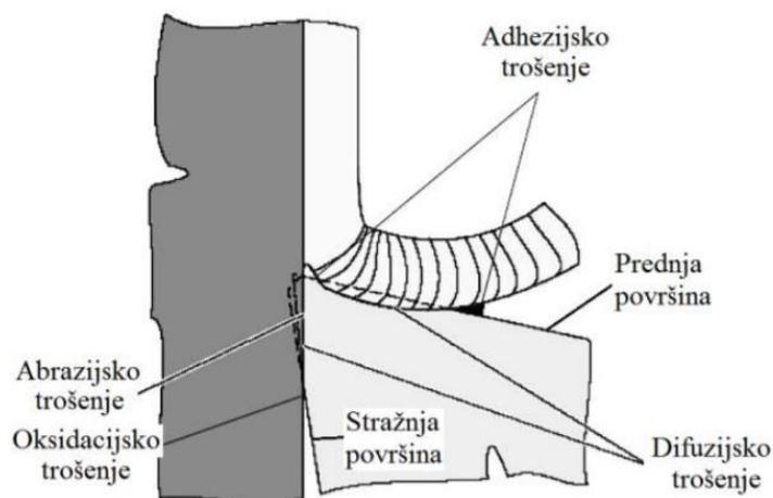
Slika 19. Karakteristična područja trošenja na reznoj oštrici alata [4]
