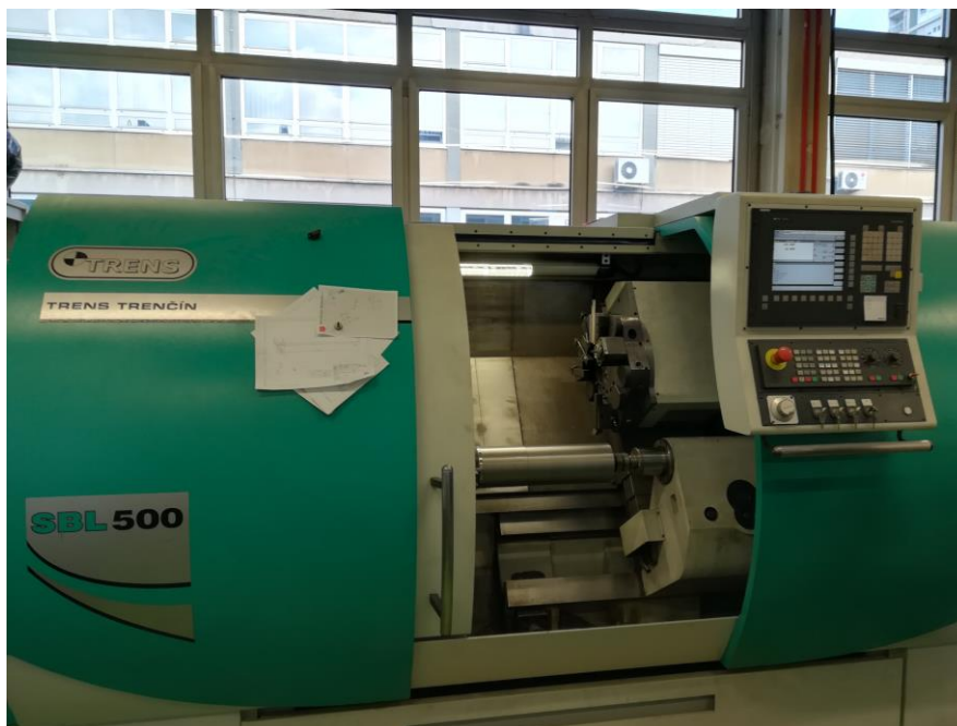
Slika 38. Tokarski obradni centar SBL 500
