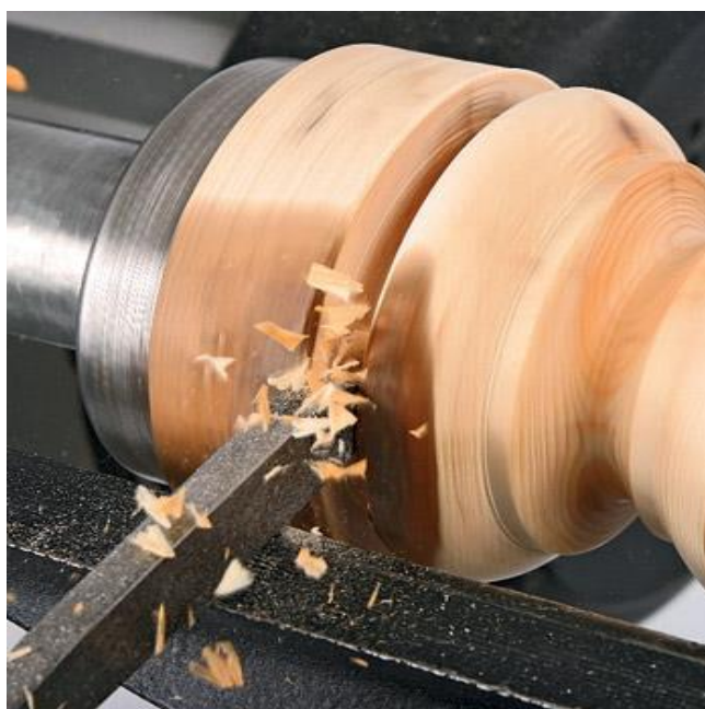
Slika 20. Prikaz tangencijalnog zahvata alata i obratka [15]
