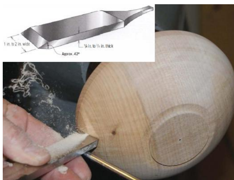
Slika 27. Obradak i ravan tokarski nož u zahvatu [19]
