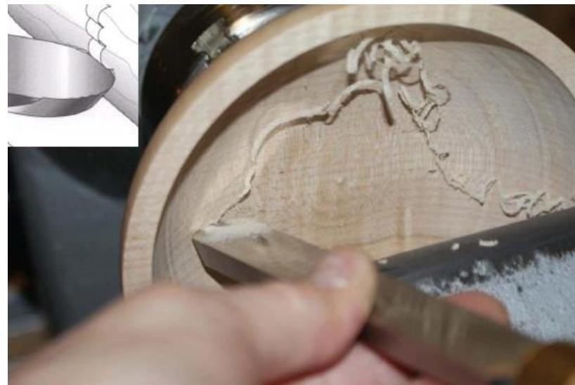
**Slika 26. Obradak u zahvatu sa oblim tokarskim nožem [19]**
