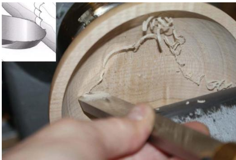
Slika 26. Obradak u zahvatu sa oblim tokarskim nožem [19]
