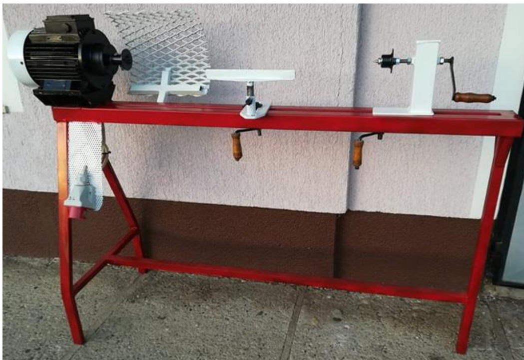
Slika 32. Prototip modelarske tokarilice
