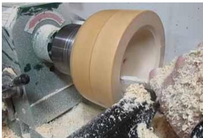
Slika 16. Poprečno unutarnje tokarenje [13]
