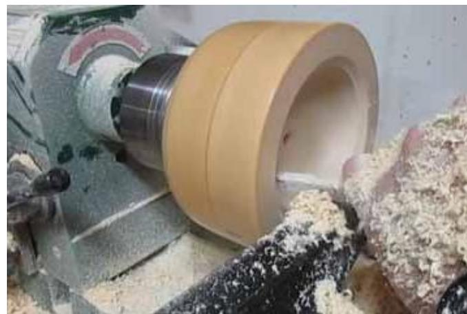
Slika 16. Poprečno unutarnje tokarenje [13]
