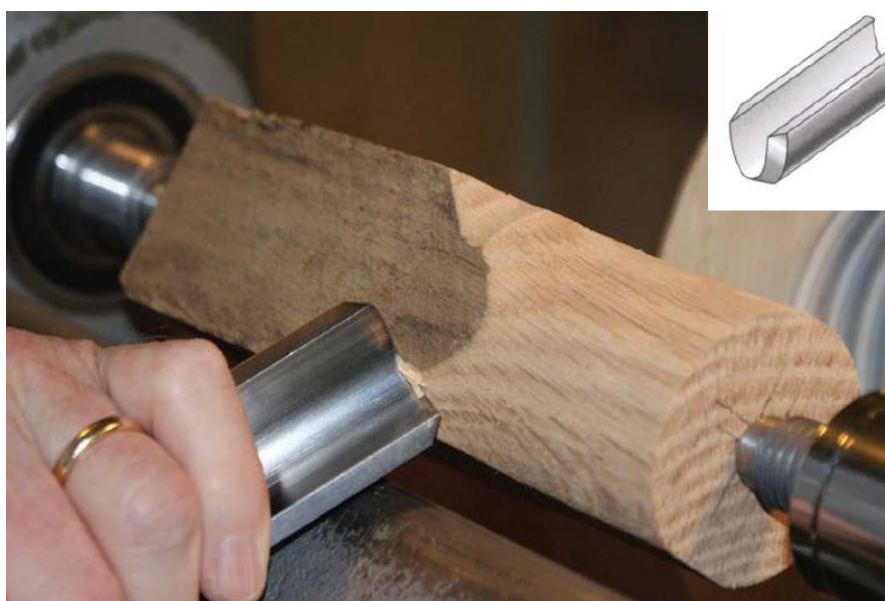
Slika 25. Tokarski alat za poravnavanje u zahvatu [19]
