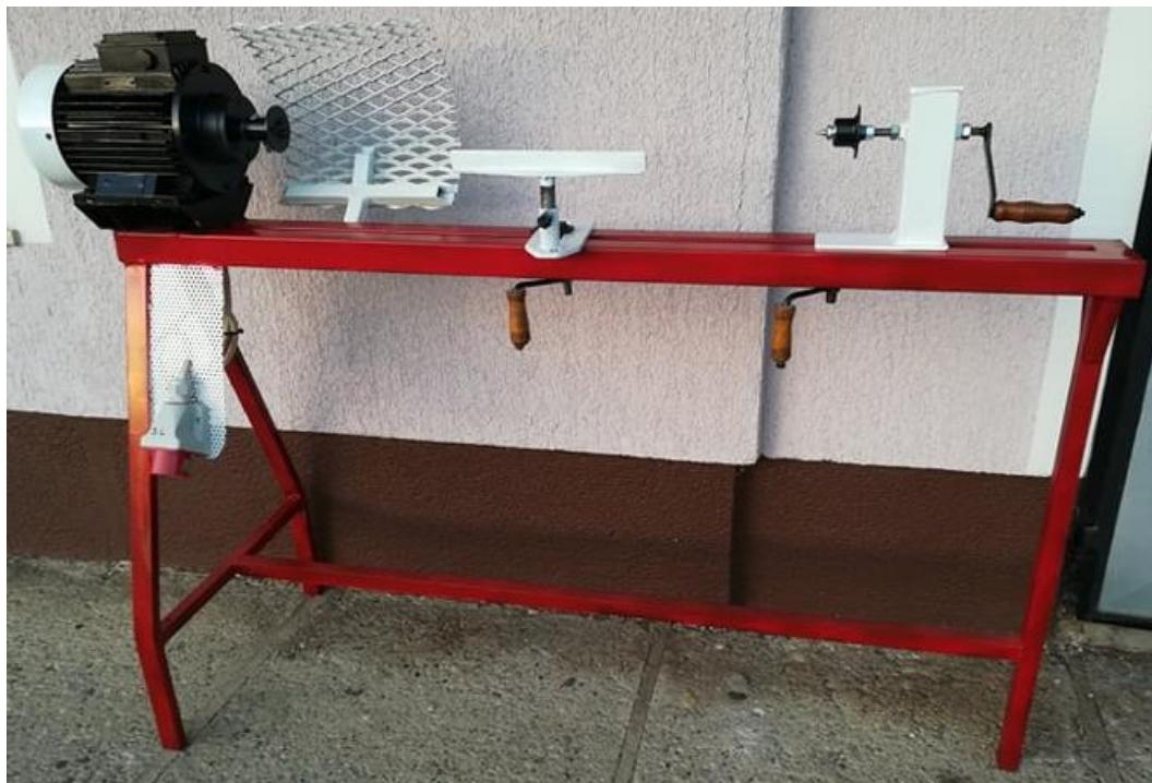
Slika 32. Prototip modelarske tokarilice
