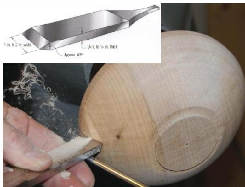
**Slika 27. Obradak i ravan tokarski nož u zahvatu [19]**
