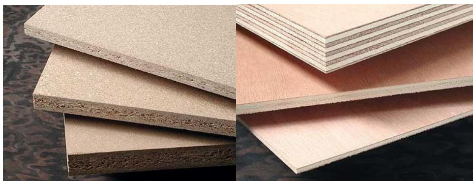
Slika 5. Iverica (lijevo) i špreploča (desno) [8]
