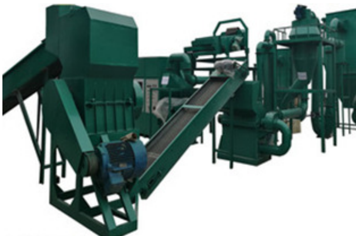
slika 5. Pogon za preradu elektroničkog otpada
