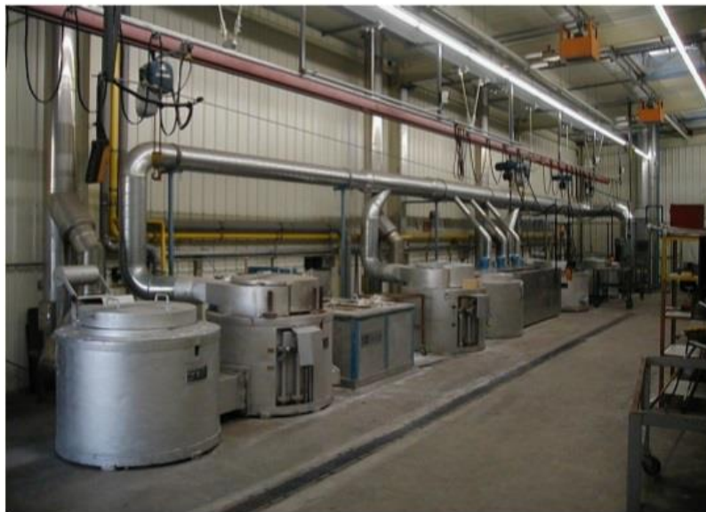
Slika 13. Postrojenje za nitriranje u solnim kupkama [13]
