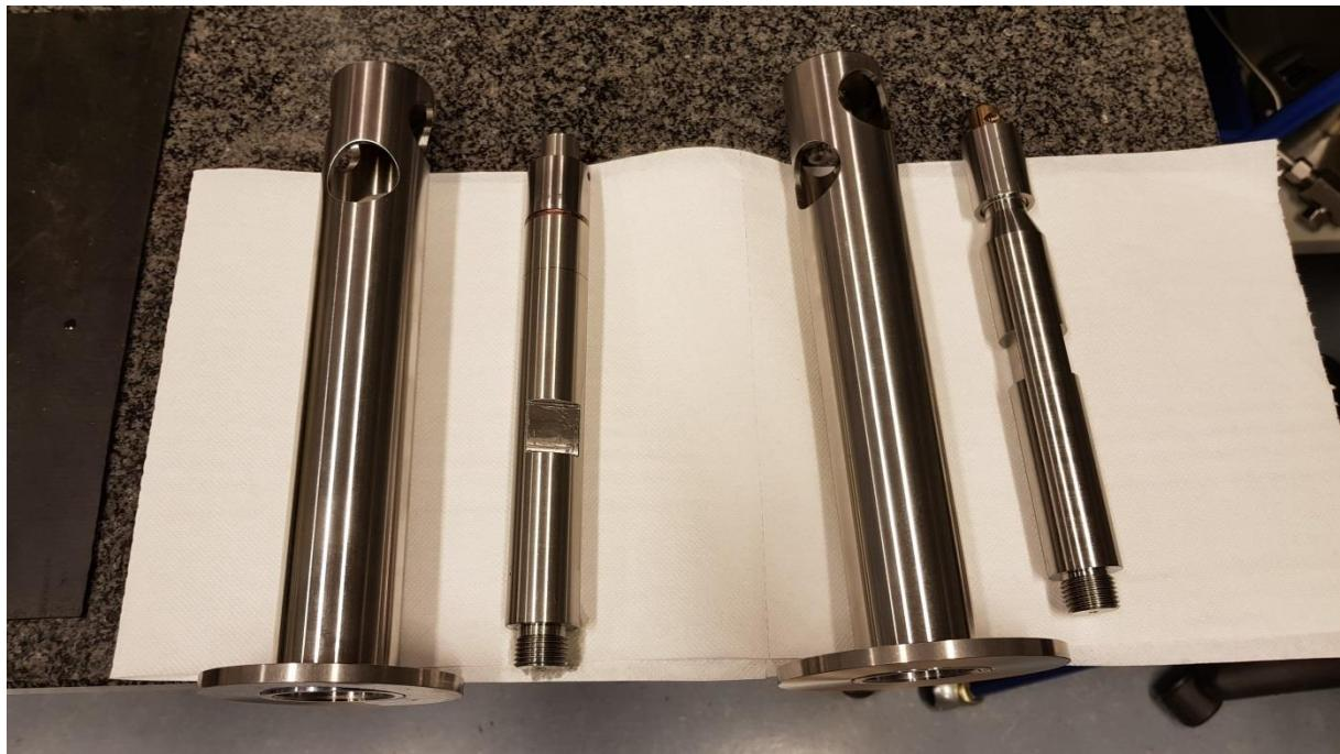
Slika 6. Sklopovi TLVAG 07 i TLVAG 08 s pripadajućim osnovnim utezima
