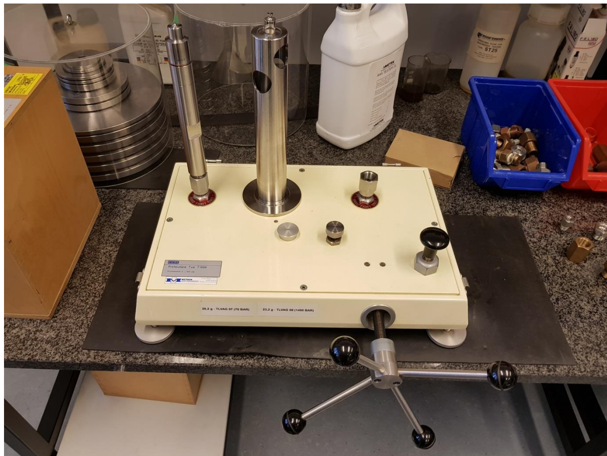
Slika 5. Tlačna vaga WIKA T1300
