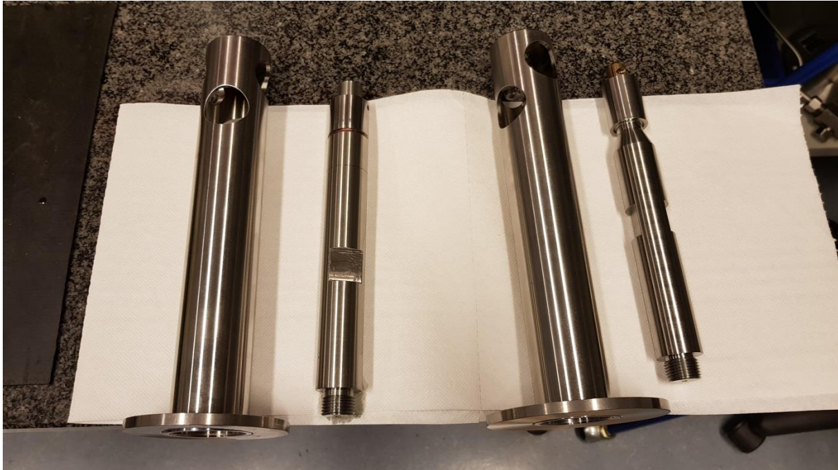
Slika 6. Sklopovi TLVAG 07 i TLVAG 08 s pripadajućim osnovnim utezima
