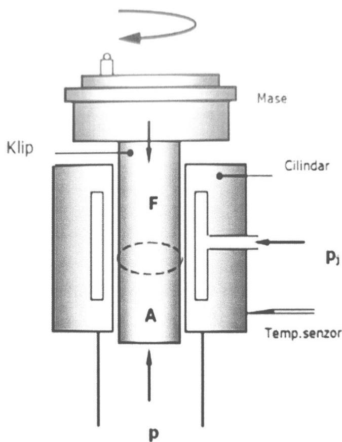
Slika 1. Sklop klip cilindar
