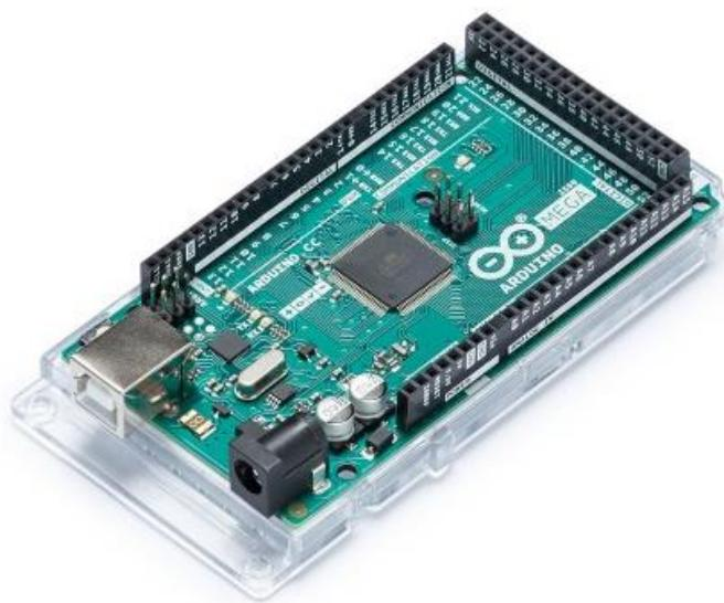
**Slika 28. Mikrokontroler Arduino Mega 2560**
