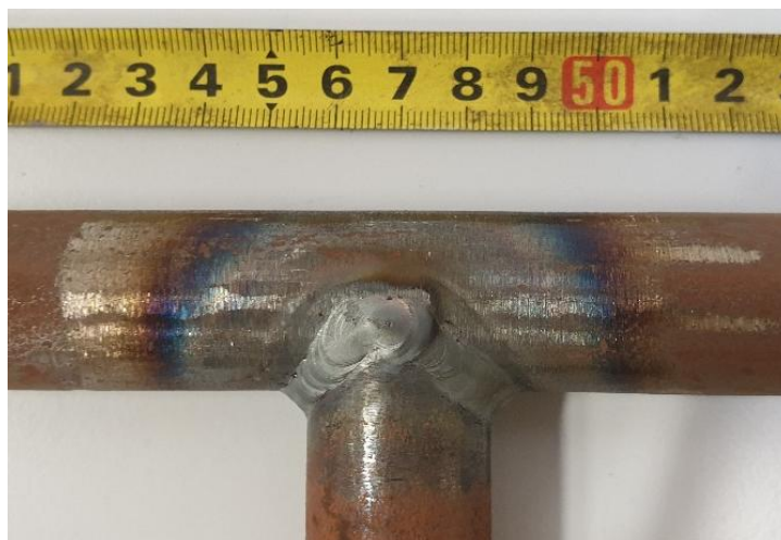
Slika 15. Zavareni kutni spoj
