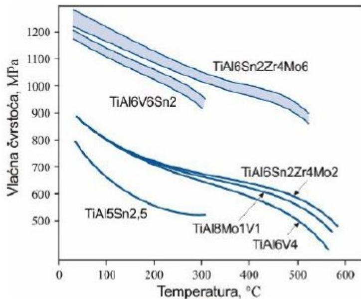
Slika 1. Vlačna čvrstoća pri povišenim temperaturama za odabране Ti-legure [2, 3]
