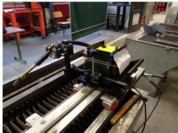
Slika 25. „BUGO Systems“ sustav za mehanizaciju postupka zavarivanja [2].
