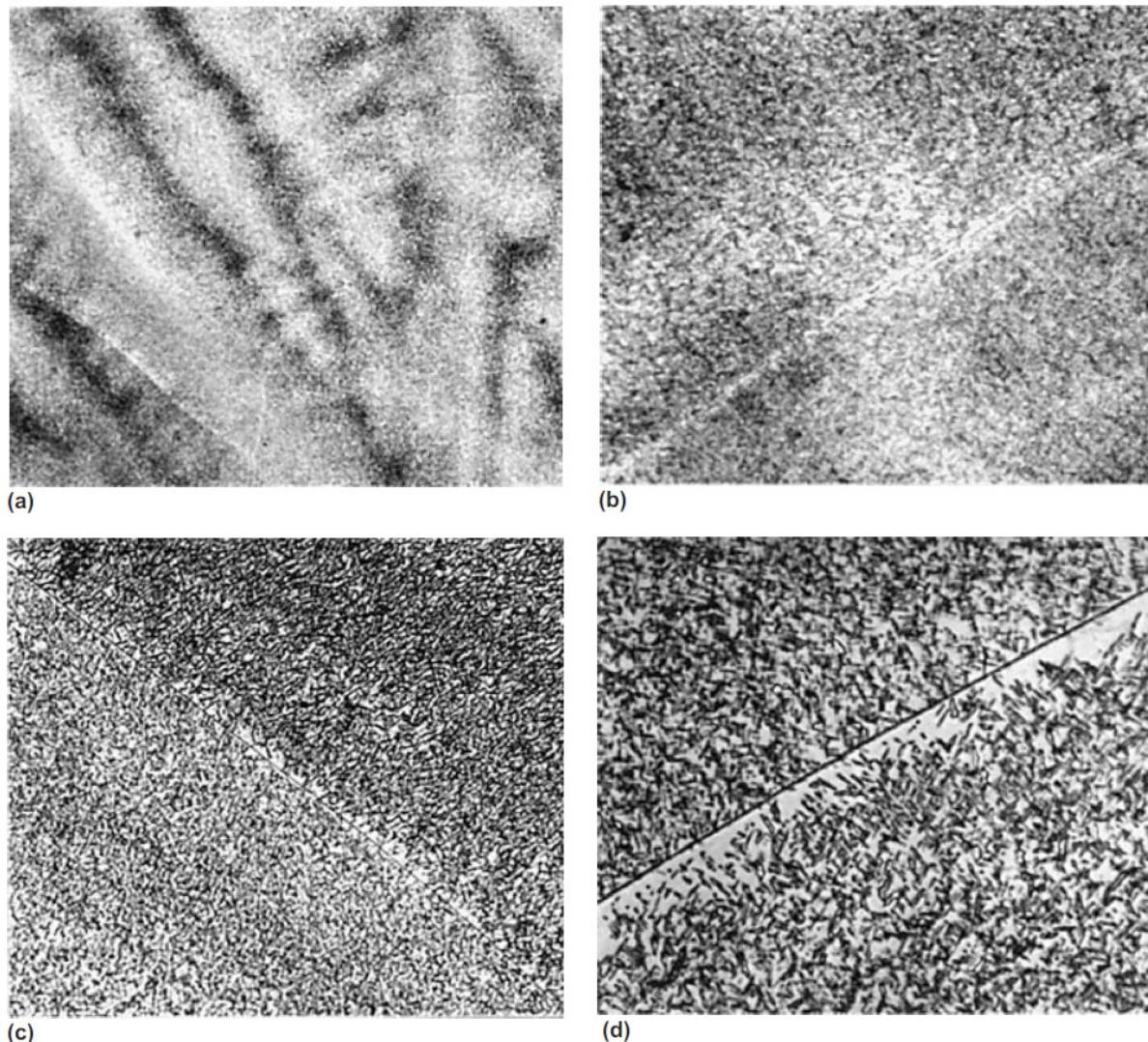
**Slika 10. Mikrostruktura zavarenog spoja izvedenog TIG postupkom zavarivanja nakon toplinske obrade. (a) Dozrijevano pri  $482\text{ }^{\circ}\text{C}$  na 24h, 275x. (b) Isto kao (a), 690x uvećano. (c) Dozrijevano na  $593\text{ }^{\circ}\text{C}$  na 8h, 275x. (d) Isto kao (c), 690x uvećano [1].**
