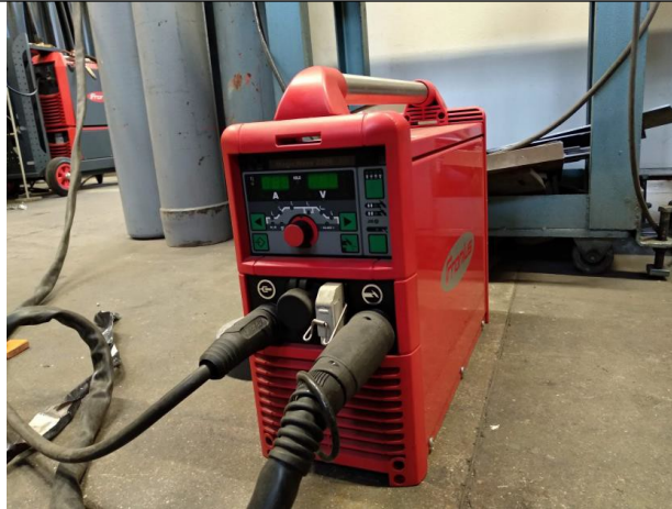
Slika 24. Fronius MagicWave 2200 Job G/F korišten u eksperimentu [2].
