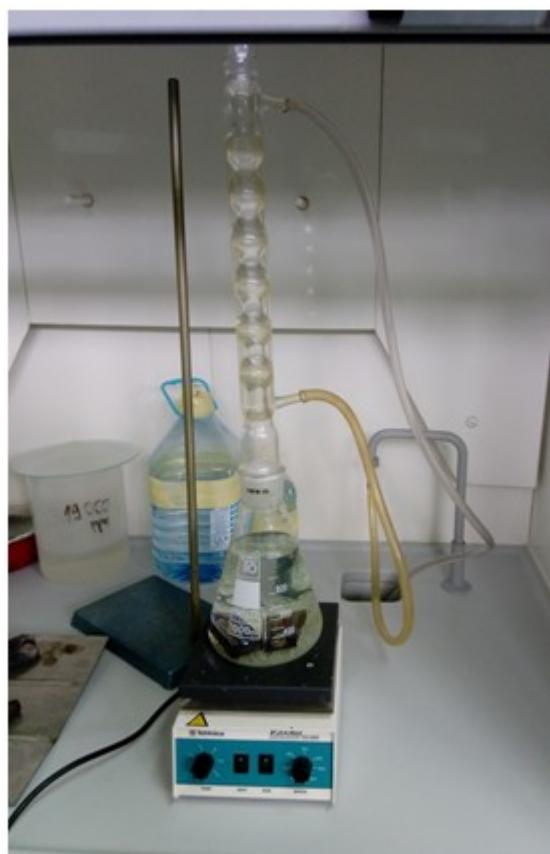
**Slika 28. Ispitivanje uzorka u 5% otopini NaCl**
