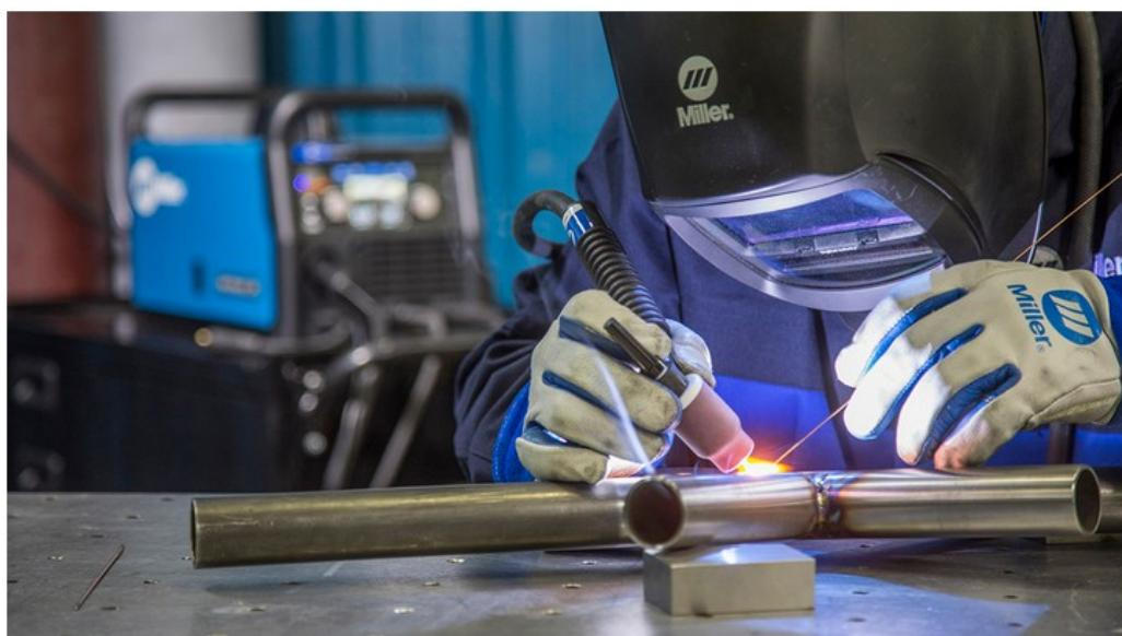
Slika 17. TIG postupak zavarivanja [20]
