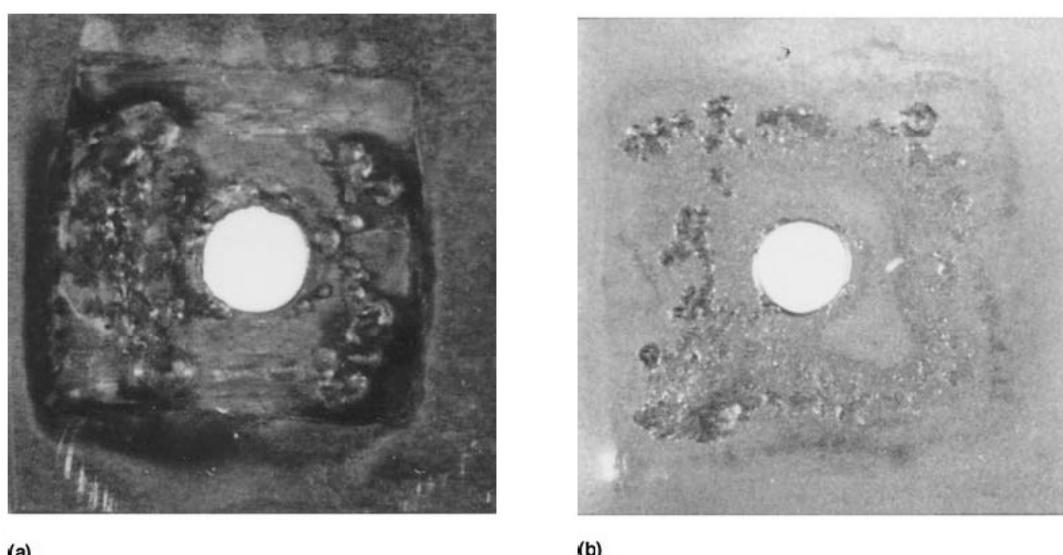
**Slika 20. Korozija u procijepu nelegiranog titanija u procijepu između podložne pločice i metala nakon izlaganja u vrućoj kloridnoj kupki. (a) Prijе čišćenja. (b) Poslije čišćenja [22]**
