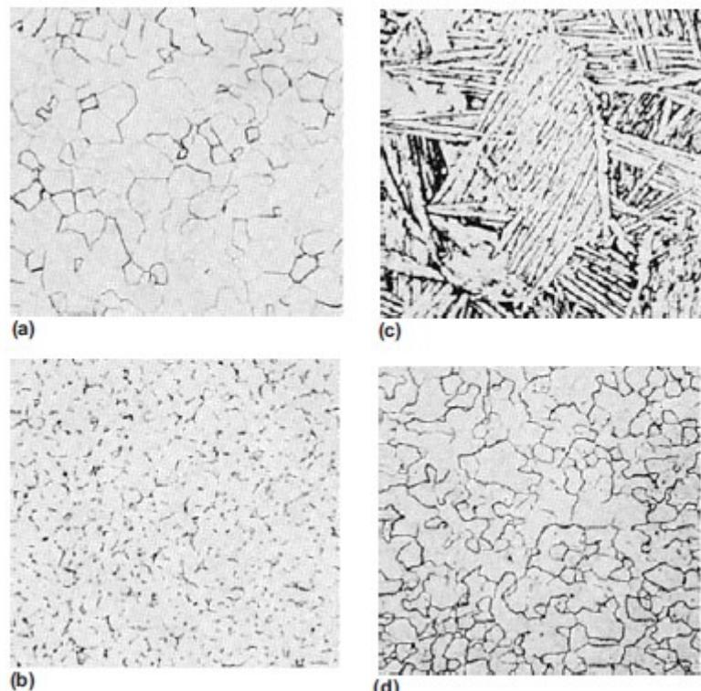
Slika 5. Tipične mikrostrukture od alfa, alfa+beta i beta titanijskih legura. (a) Alfa u nelegiranom titaniju nakon 1h pri  $699^{\circ}\text{C}$ . (b) Alfa+beta. (c) Igličasta zrna alfa+beta u Ti-6Al-4V leguri. (d) Beta u Ti-13V-11Cr-3Al leguri [1].
