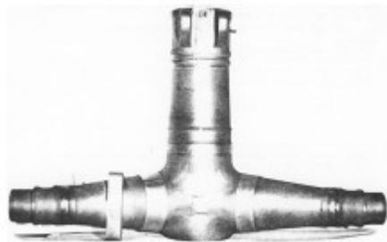
**Slika 13. Greda podvozja zrakoplova IL76 napravljena od Ti-2.5Al-5V-5Mo-1.3Cr-1Fe legure [9]**
