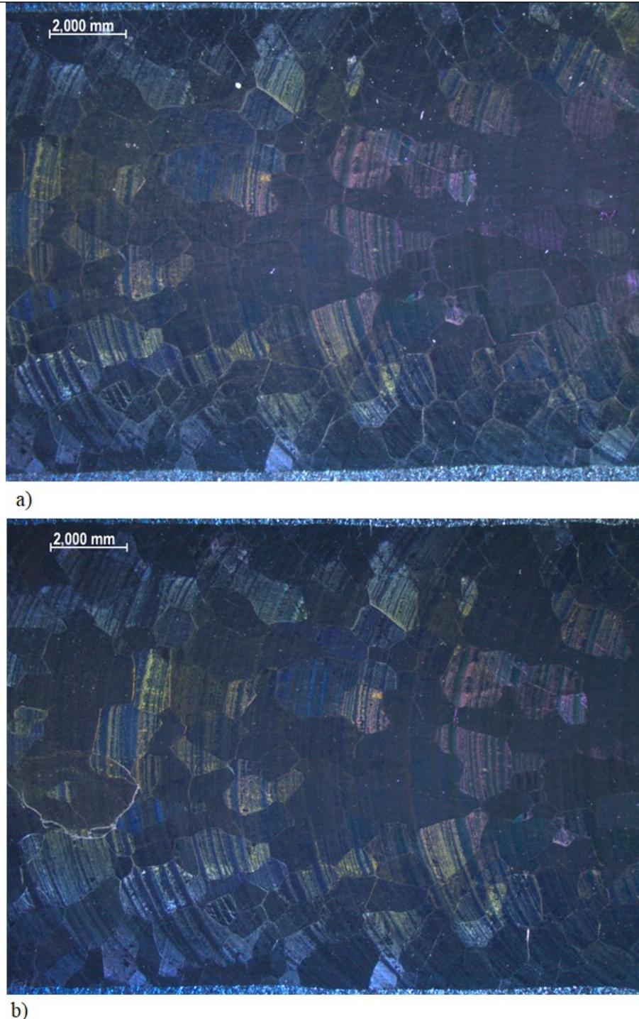
**Slika 38. Izgled navara na sredini uzorka B2. (a) Prije ispitivanja. (b) Poslije ispitivanja.**
