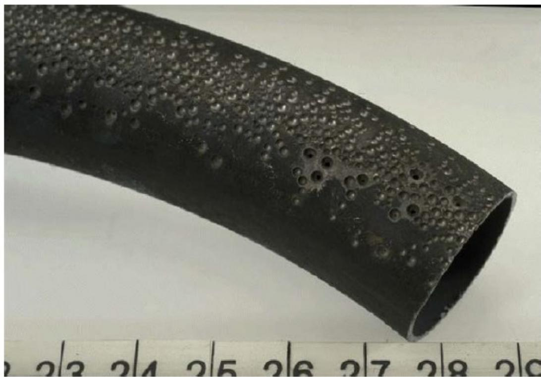
Slika 22. Rupičasta korozija u obliku malih jamica po površini cijevi [24]
