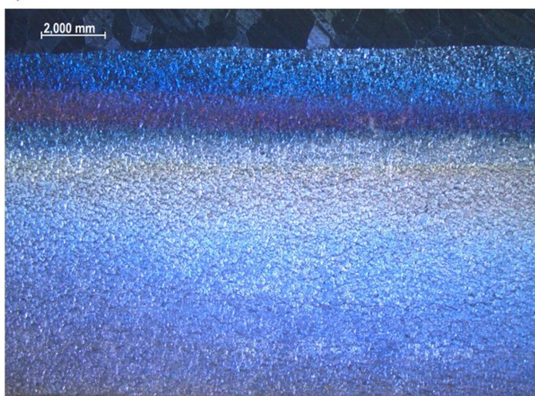
**Slika 36. Izgled površine ZUT-a na sredini uzorka B2. (a) Prije ispitivanja. (b) Poslije ispitivanja.**
