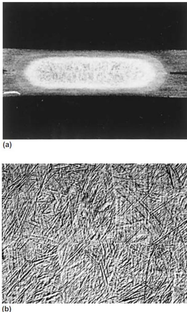
Slika 6. Beta zrna u točkastom zavarivanju alfa-beta legure Ti-6Al-4V. (a)10x. (b) 240x [1]
