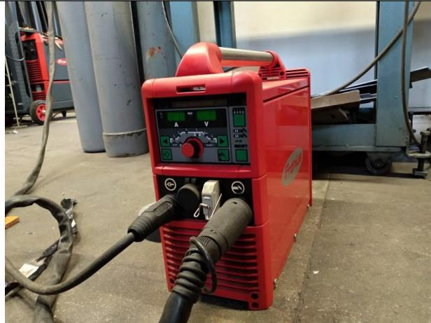
Slika 24. Fronius MagicWave 2200 Job G/F korišten u eksperimentu [2].
