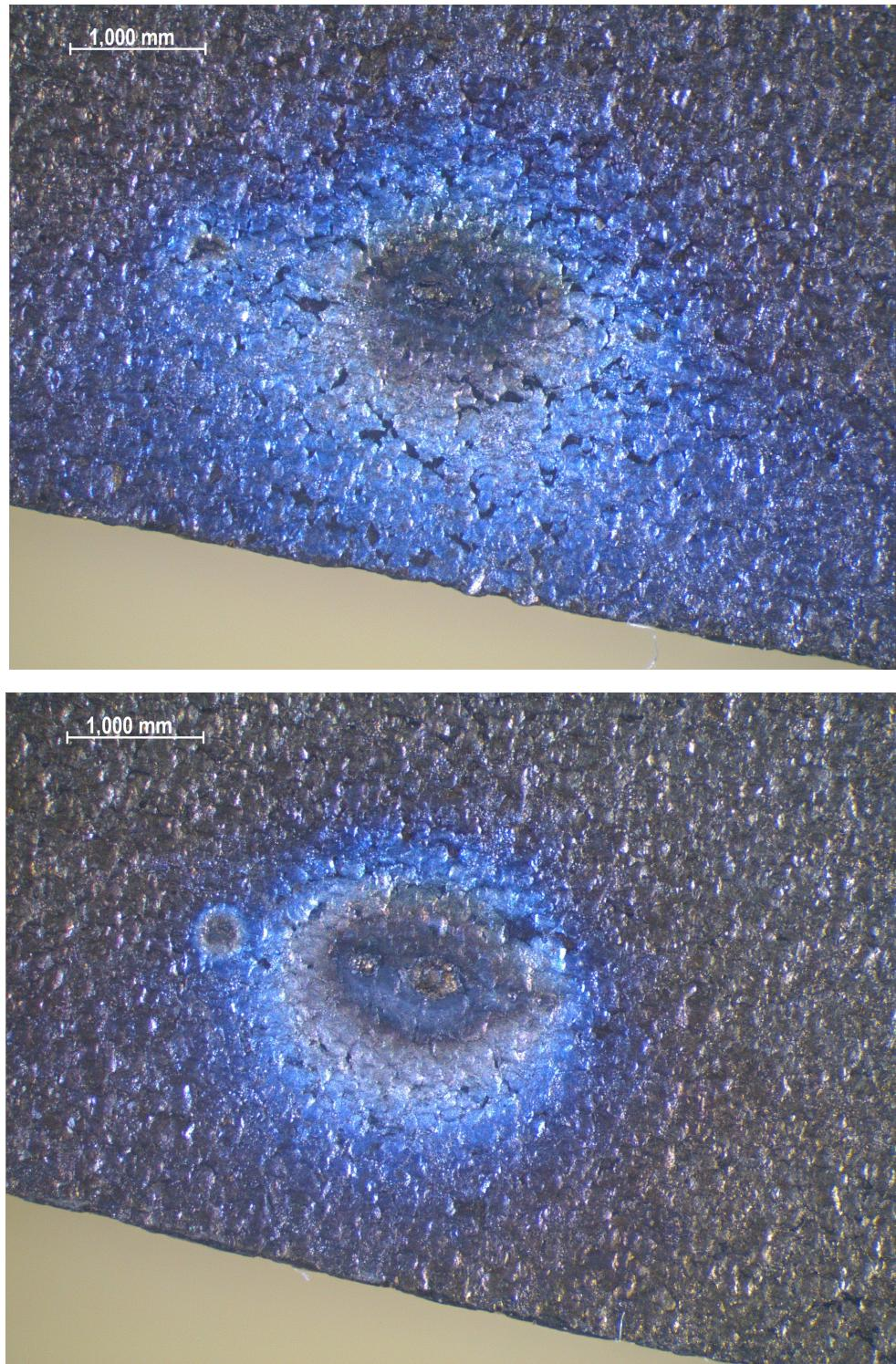
**Slika 39. Korozijska oštećenja na suprotnoj površini od navara uzorka B2.**
