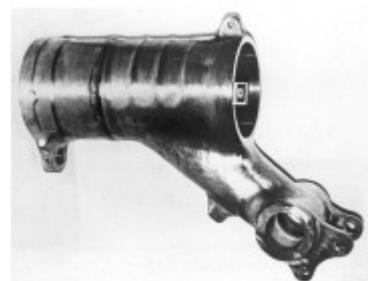
**Slika 14. Nos podvozja zrakoplova IL76 [9]**
