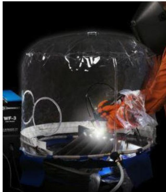
**Slika 11. Izvođenje postupka zavarivanja u komori za zavarivanje [12]**
