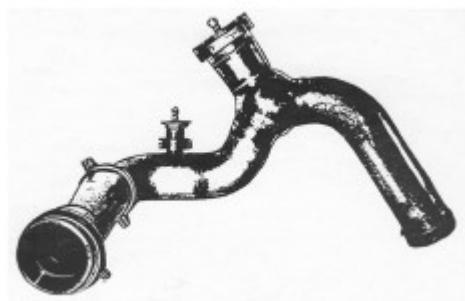
**Slika 15. Zavaren cjevovod zrakoplova od Ti-3Al-1.5Mn legure titanija [9]**
