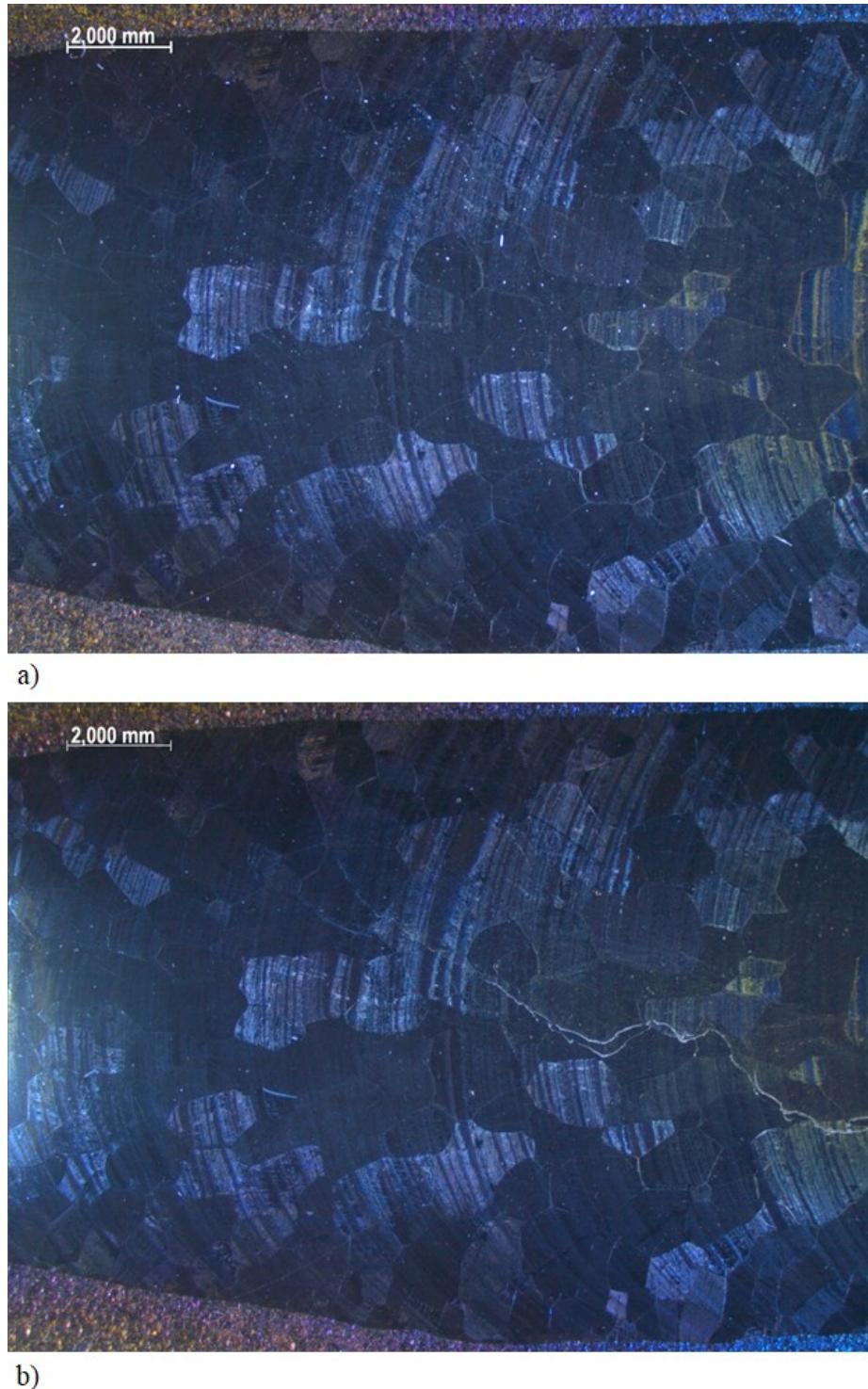
**Slika 37. Izgled navara na početku uzorka B2. (a) Prije ispitivanja. (b) Poslije ispitivanja.**
