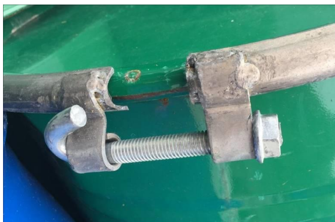
Slika 38. Način učvršćivanja obruča na bačvama
