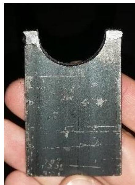
Slika 24. Čelična pločica s utorom za obujmicu
