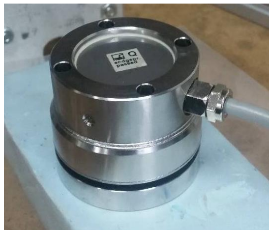
Slika 18. Vlačno-tlačni osjetnik sile HBM U3 0,5 kN
