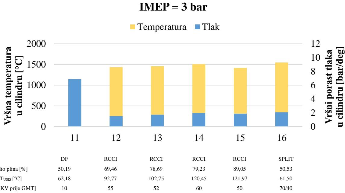
**Slika 29.** Usporedni prikaz vršnih vrijednosti temperature i porasta tlaka za točke od 11 do 16
