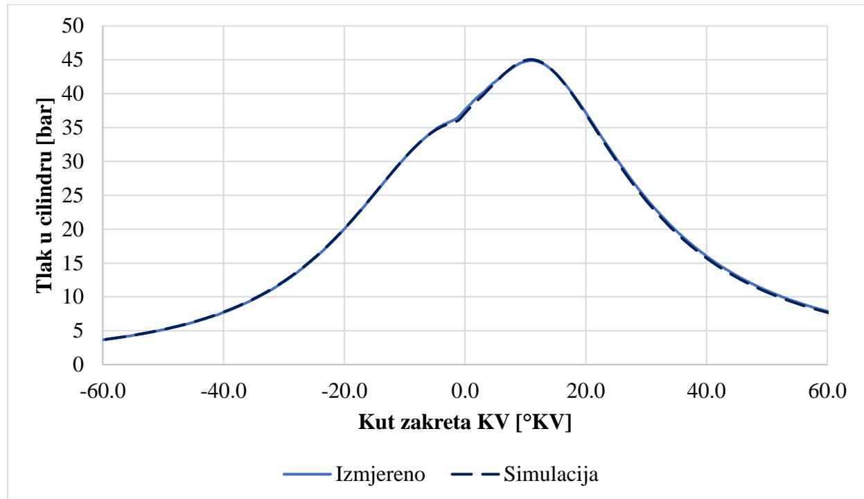
**Slika 14.** Tlak u cilindru za radnu točku 2
