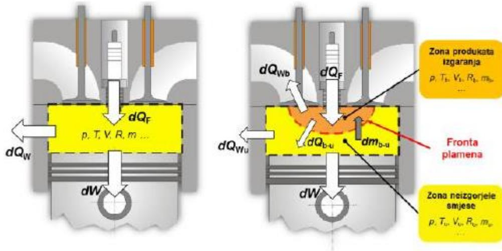
Slika 6. Jednozonski (lijevo) i dvozonski model (desno) [10]
