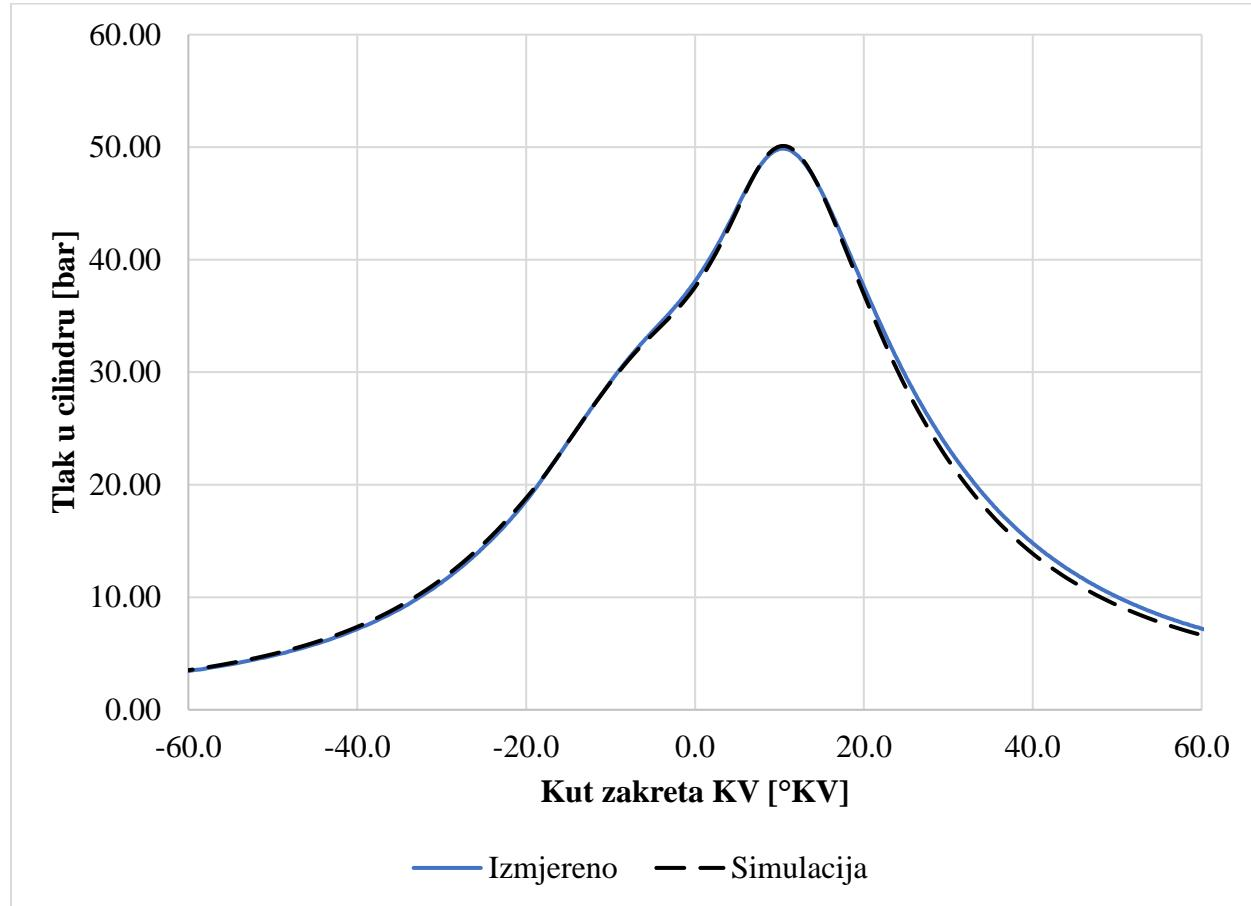
Slika 23. Tlak u cilindru za radnu točku 10
