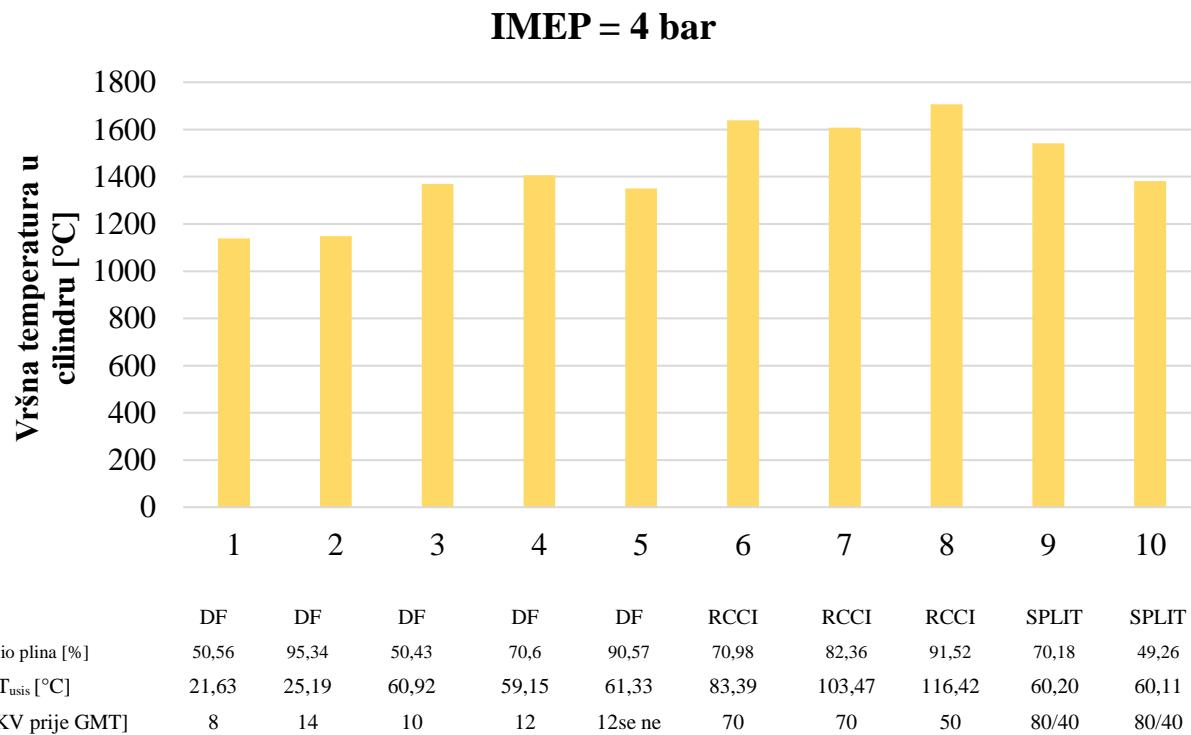
**Slika 24.** Vršna temperatura u cilindru za točke od 1 do 10
