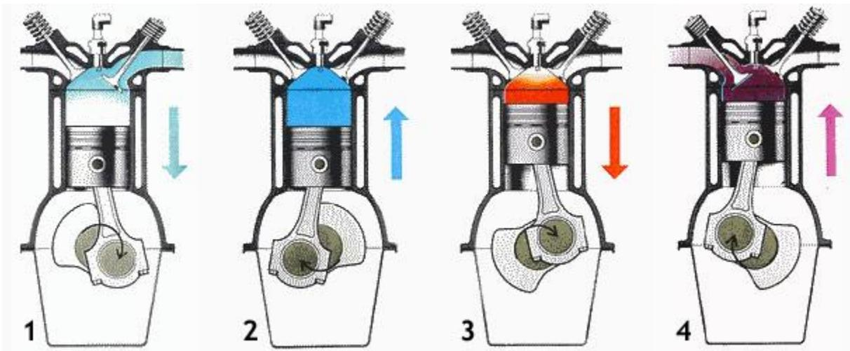
**Slika 1.** Prikaz dijelova radnog procesa 4-taktnog motora [2]
