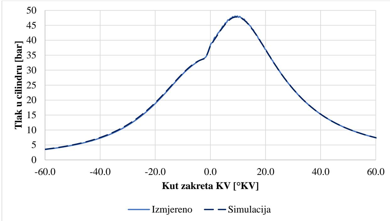
Slika 15. Tlak u cilindru za radnu točku 5
