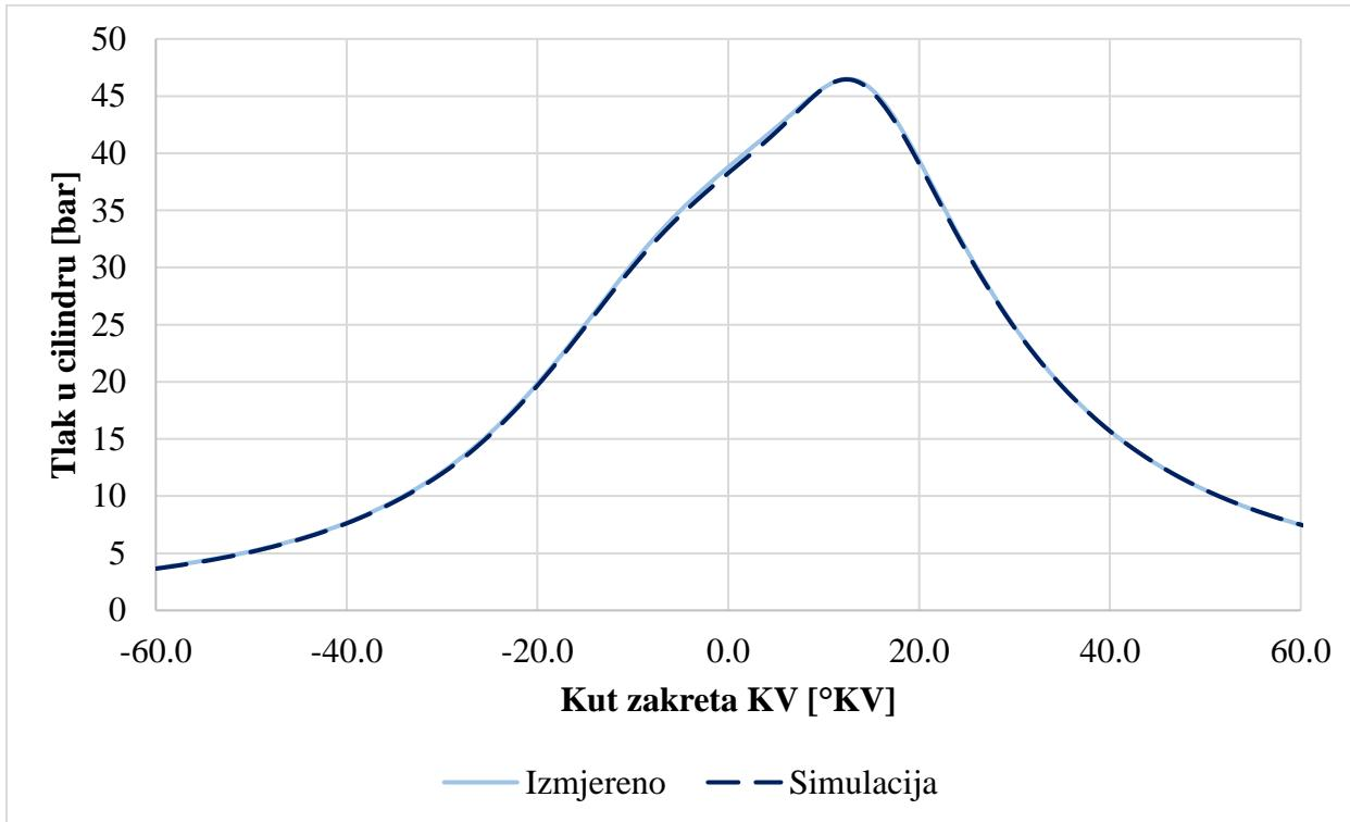
Slika 16. Tlak u cilindru za radnu točku 7
