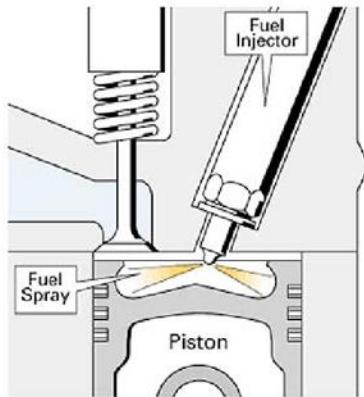
**Slika 2.** Direktno ubrizgavanje goriva u cilindar kod Diesel motora [3]
