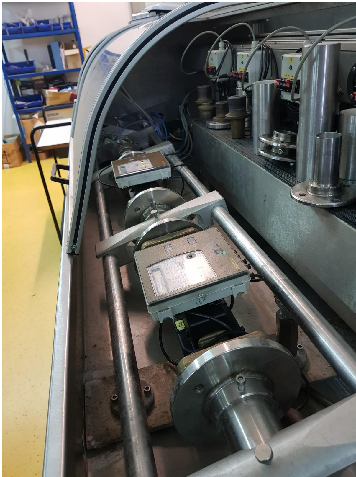
Slika 19. Mjerilo protoka spojeno na mjernu liniju
