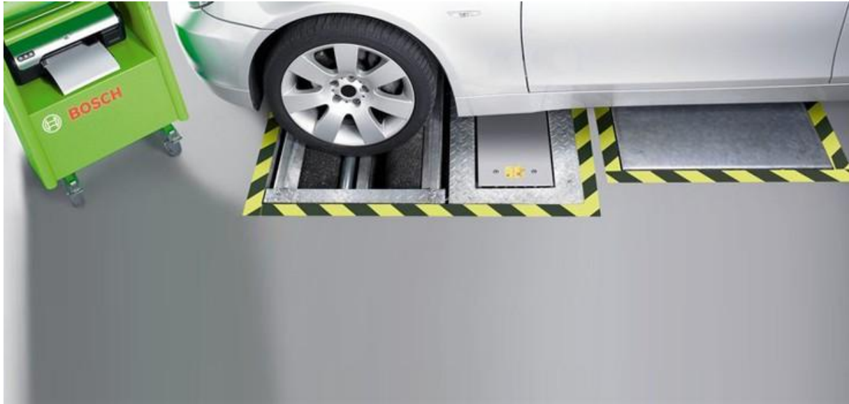
Slika 2. Ispitivanje kočnica na valjcima za tehnički pregled [4]
