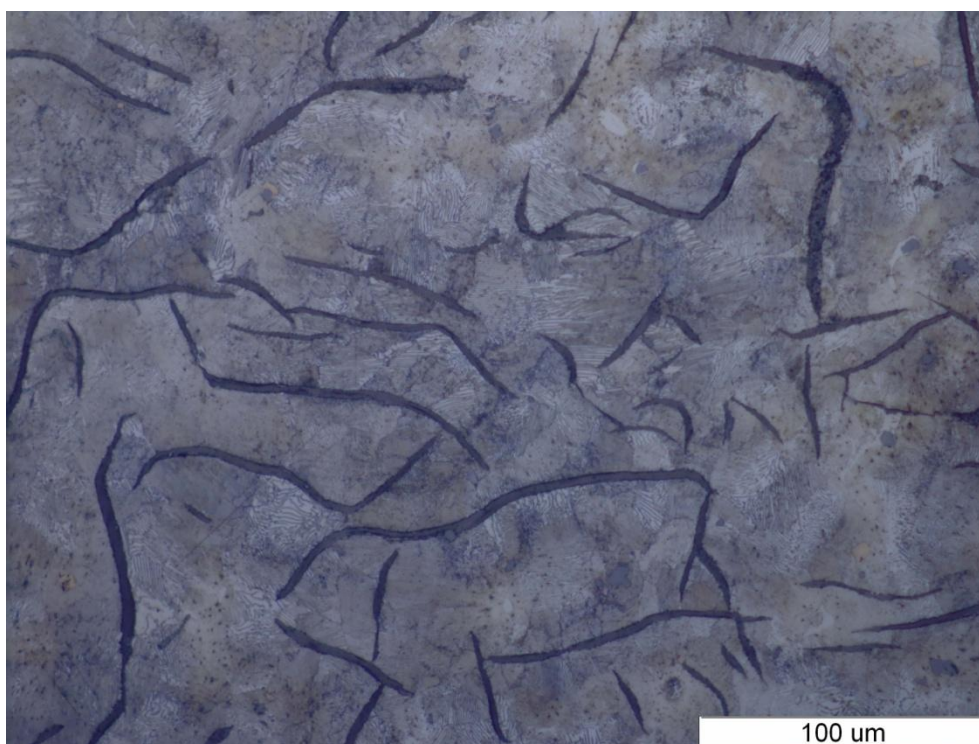
Slika 67. Mikrostruktura nagrižene površine kočionog diska 1 pri povećanju od 500x
