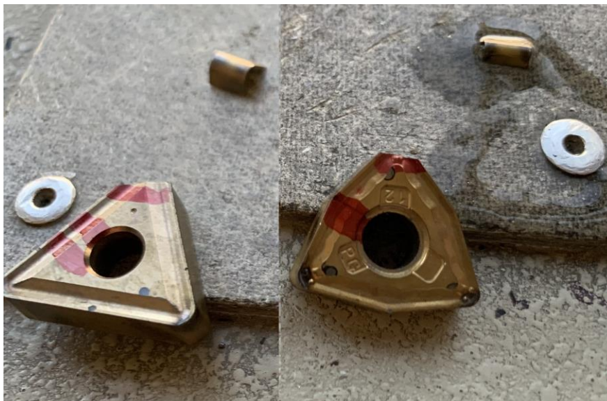
Slika 15. Prikaz metalografskih uzoraka nakon rezanja
