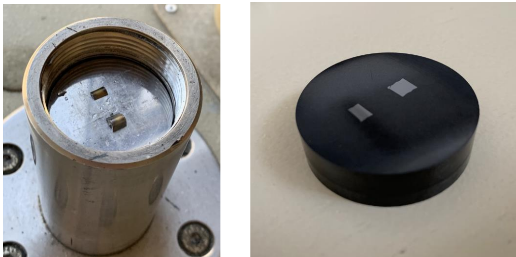
Slika 16. Zalijevanje uzoraka u polimernu masu
