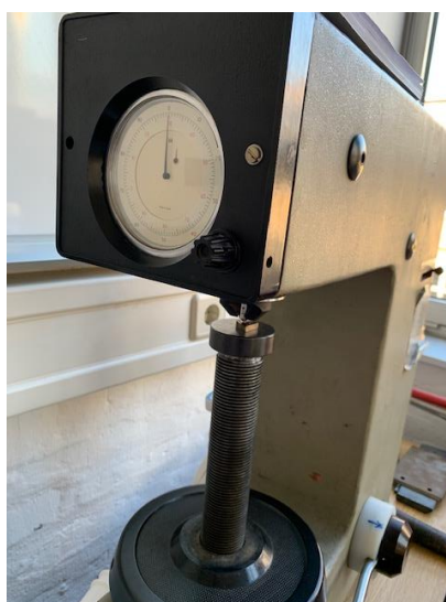
Slika 13. Uređaj za mjerenje tvrdoće po Rockwellu
