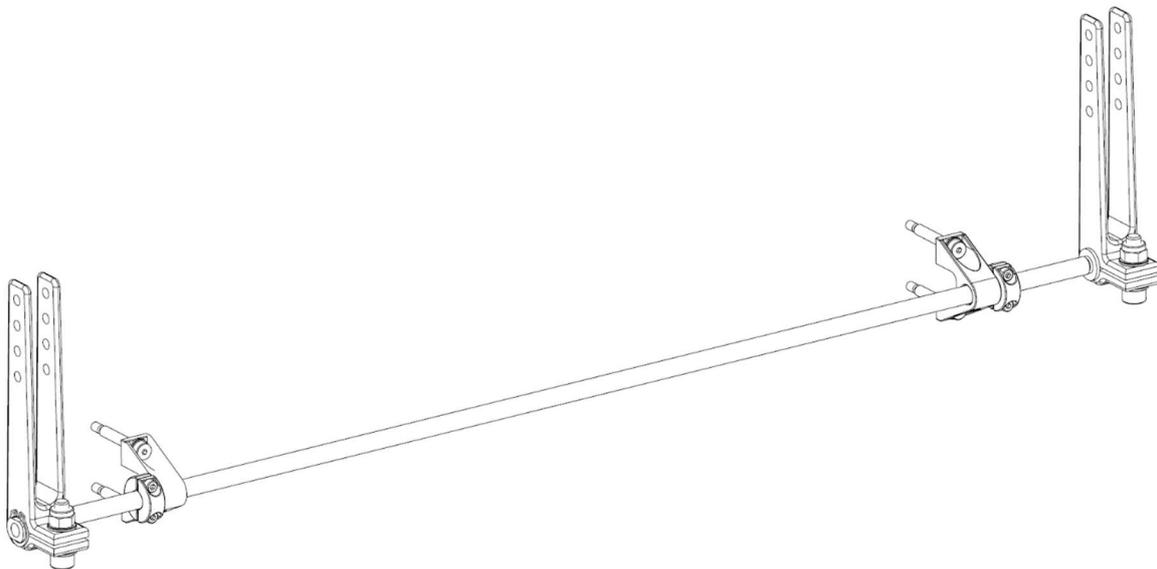
**Slika 52. Sklop stražnjeg stabilizatora**
