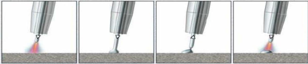
Slika 3.3 Faze CMT postupka zavarivanja
