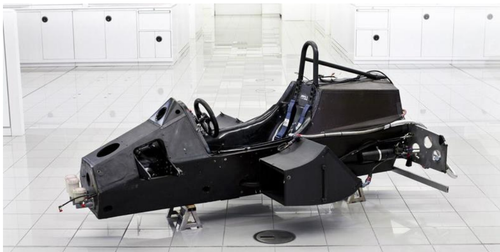
Slika 7. Monocoque šasija McLaren MP4/1 [6]
