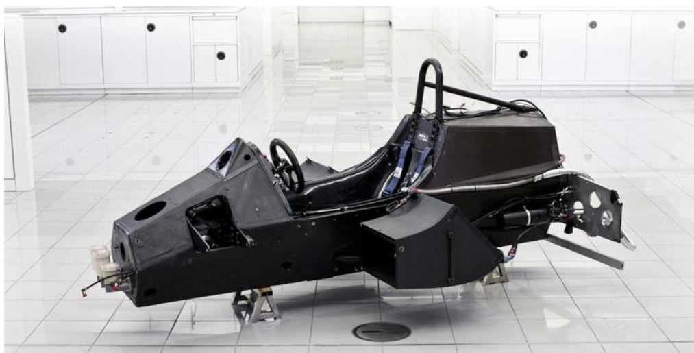
Slika 7. Monocoque šasija McLaren MP4/1 [6]
