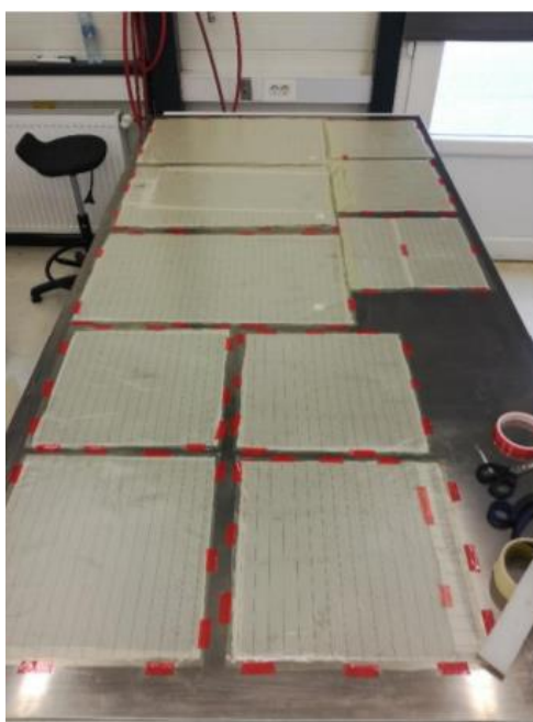
Slika 32. Postavljanje odjeljivača prije prvog umrežavanja
