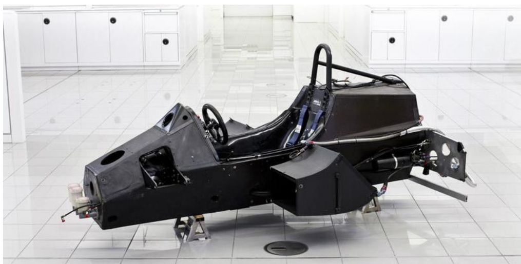
Slika 7. Monocoque šasija McLaren MP4/1 [6]
