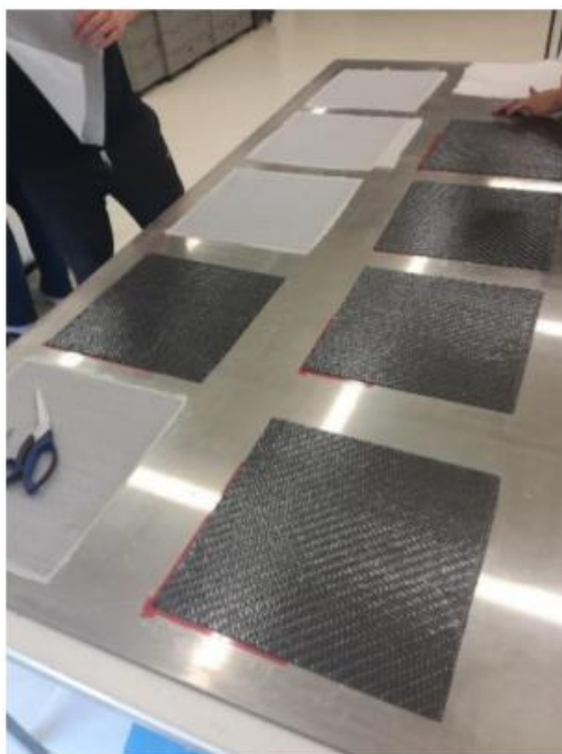
Slika 31. Postavljanje tkanine za odijeljivanje
