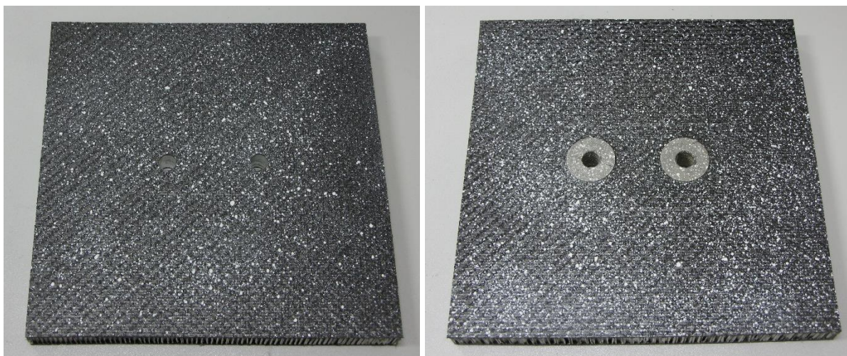
Slika 48. Uzorci nakon nanošenja stohastičkog rastera
