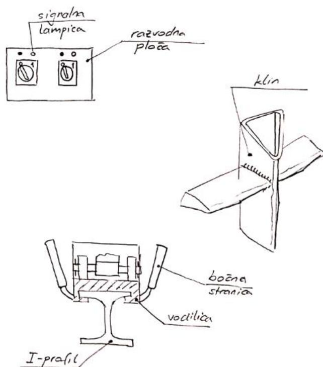
Slika 19. Detaljni prikaz pojedinih dijelova koncepta 1-2
