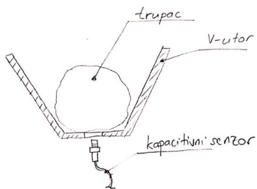
Slika 26. Predviđeno mjesto ugradnje kapacitivnog senzora
