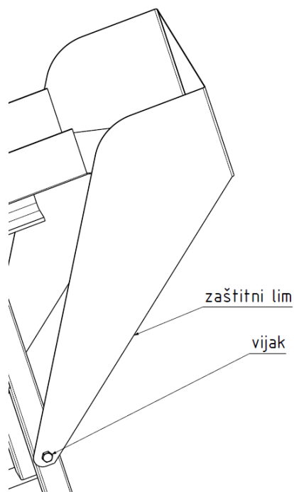
Slika 34. Položaj vijaka u konstrukciji
