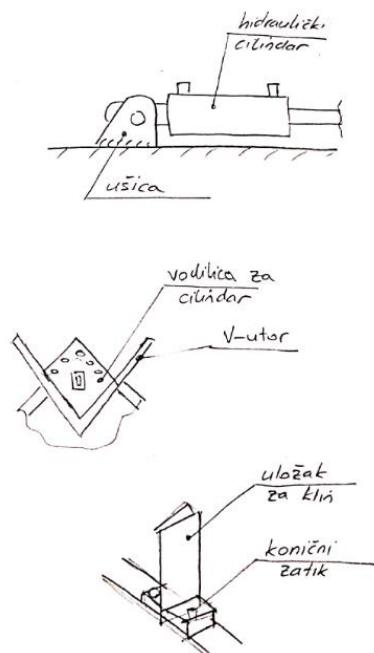
Slika 21. Detaljni prikaz pojedinih dijelova koncepta 2
