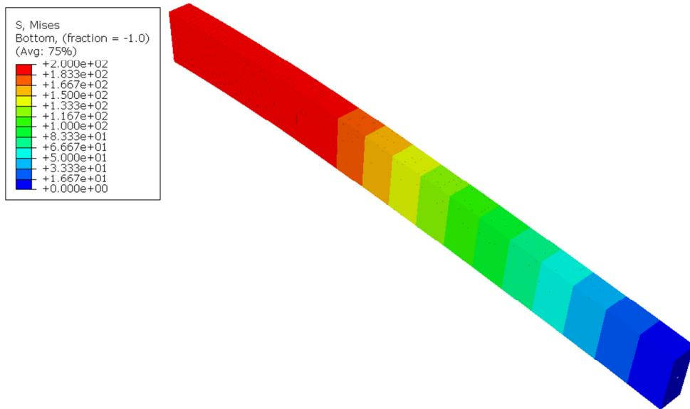
**Slika 1. 11 Raspodjela naprezanja konzolne grede prilikom graničnog stanja pri iznosu sile  $F=4500$  N.**
