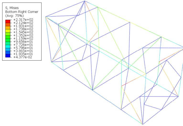
**Slika 1. 37 Raspodjela naprezanja prema von Misesu u slučaju opterećenja  $F=207,9$  kN**
