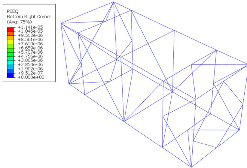
**Slika 1. 38 Rapodjela plastičnih deformacija u slučaju opterećenja  $F=214,2$  kN**
