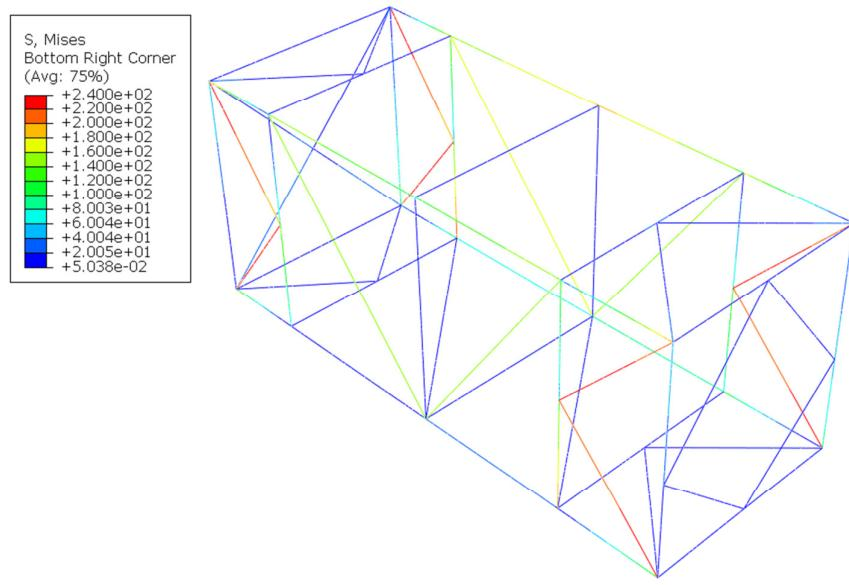
**Slika 1. 43 Raspodjela naprezanja prema von Misesu u slučaju opterećenja  $F=245,7 \text{ Kn}$**
