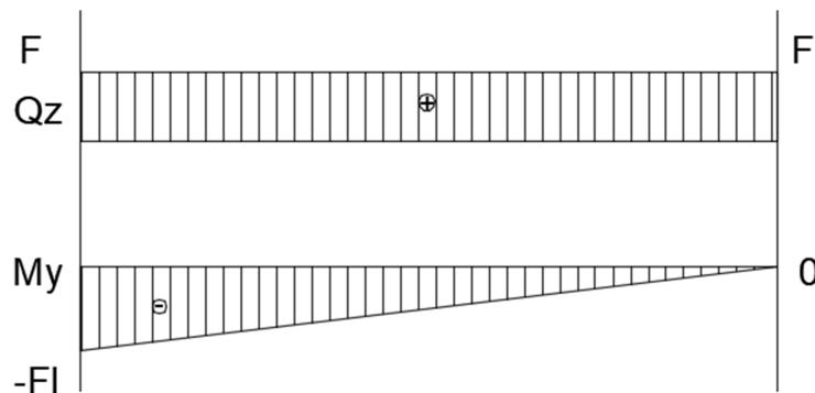
Slika 1. 7 Dijagram poprečnih sila i momenta savijanja
