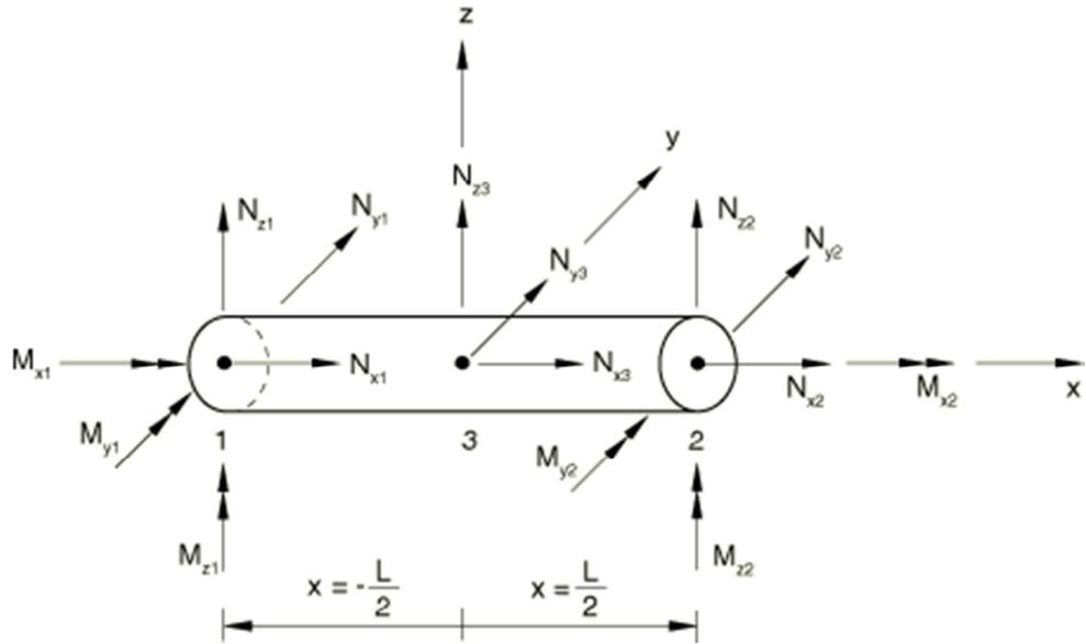
**Slika 1. 5 3D Okvirni konačni element**
