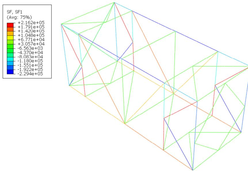
**Slika 1. 44 Raspodjela osnih sila pri iznosu sile  $F=245,7 \text{ kN}$ .**
