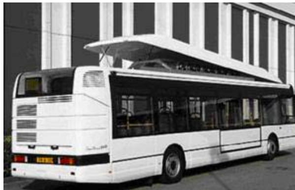
Slika 5.4. Montirani spremnici SPP-a na krovu gradskog autobusa
