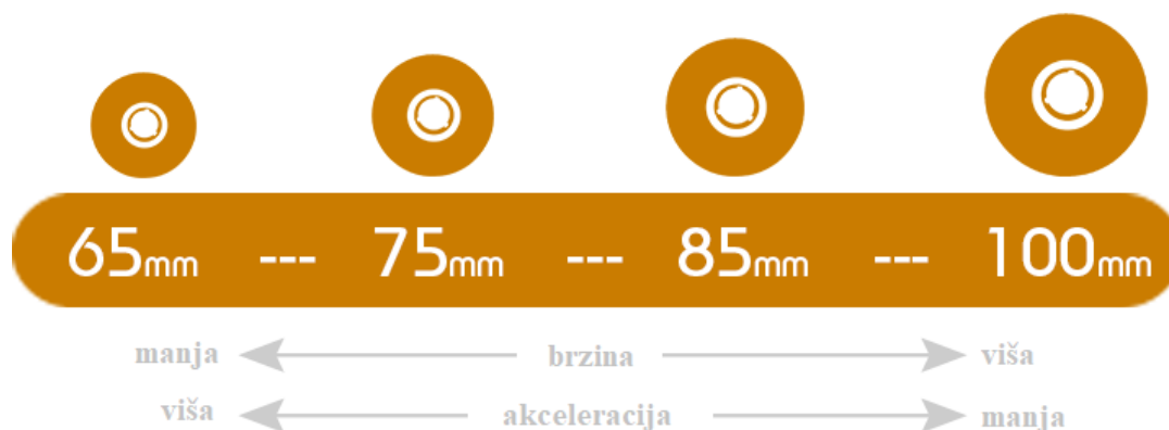
Slika 6.1. Utjecaj promjera kotača na brzinu [16]
