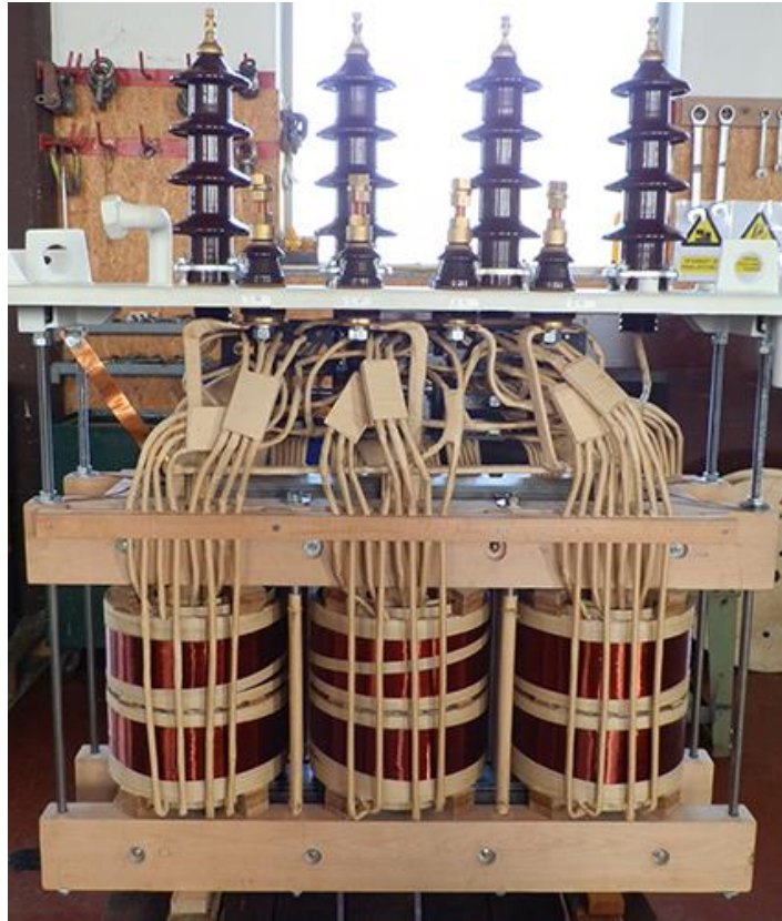
Slika 23. Izolacija trofaznog namota transformatora
