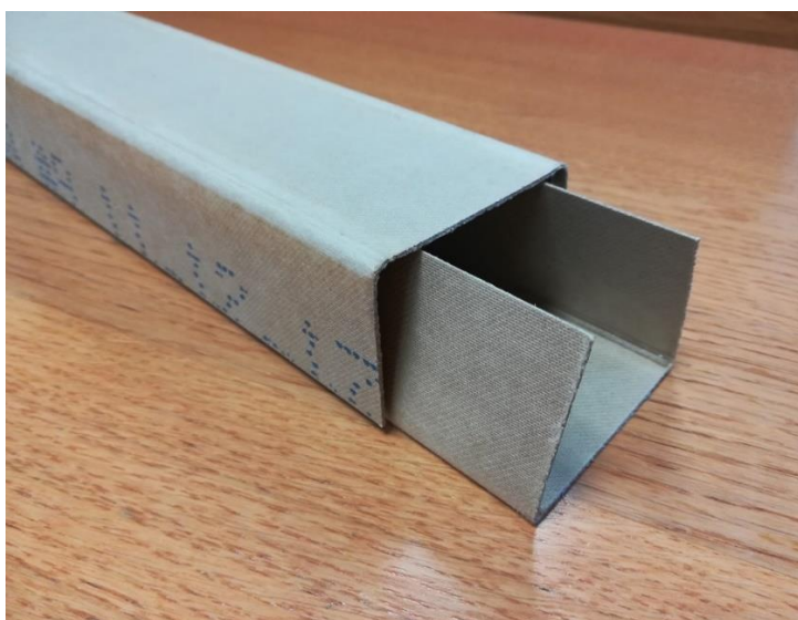
Slika 29. Barijera izrađena s rekonstruiranim alatom
