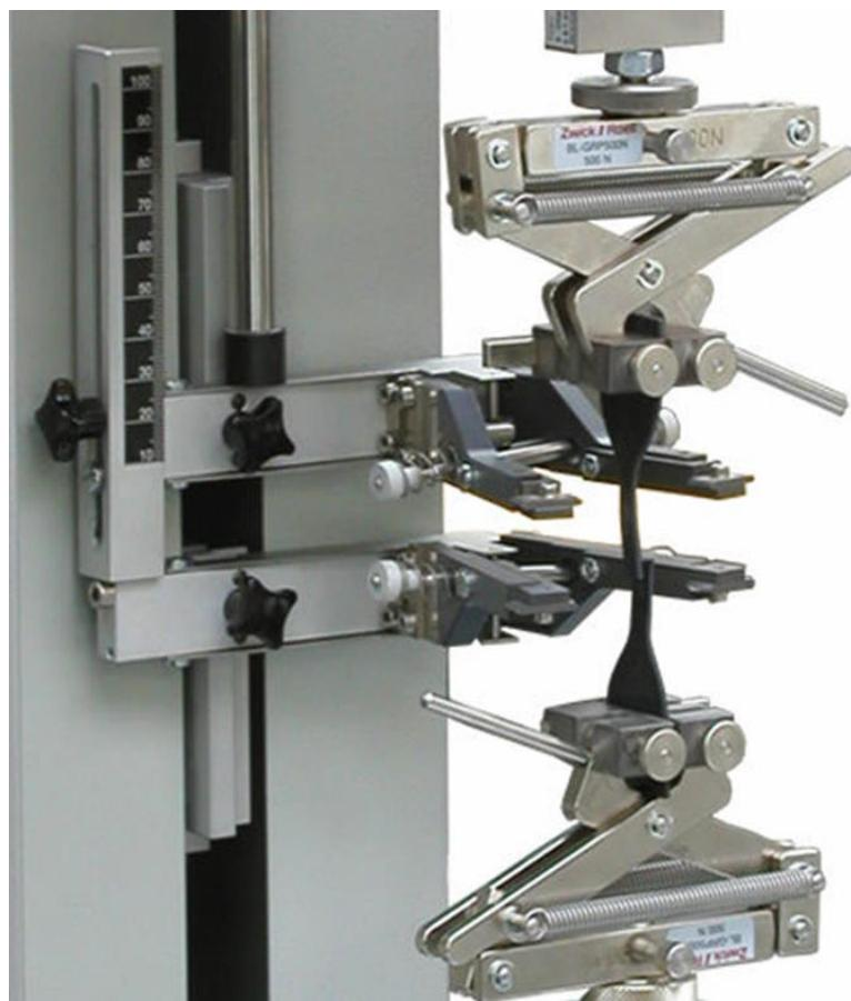
**Slika 2.6. Automatski kontaktni ekstenzometar**
