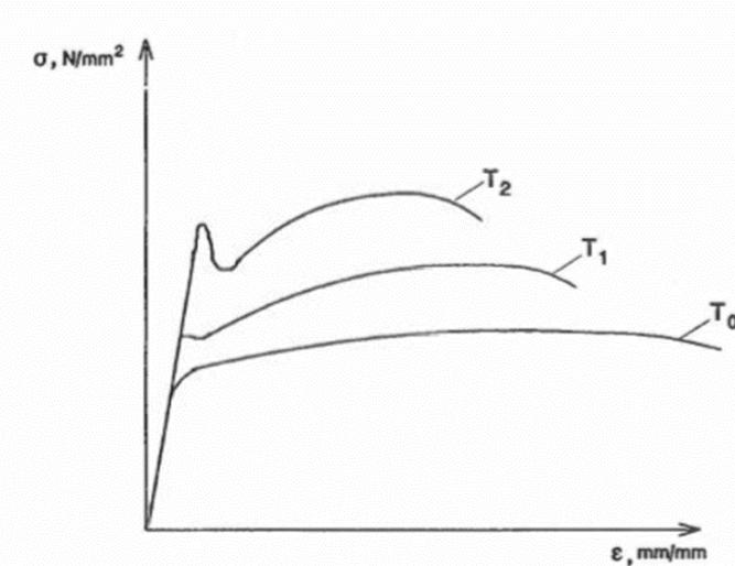
**Slika 3.5. Utjecaj snižavanja temperature za opći konstrukcijski čelik [1]**
