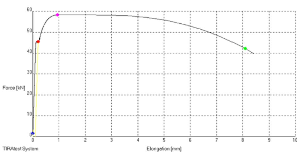
Slika P5. Dijagram sila-produljenje epruvete 2 mekog čelika na -40 °C
