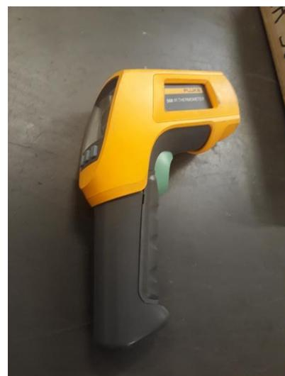
**Slika 4.5. Fluke 568 IR Thermometer**
