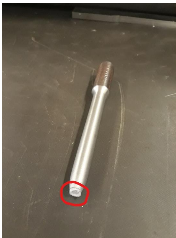
Slika 4.11. Mjesto mjerenja temperature nakon loma
