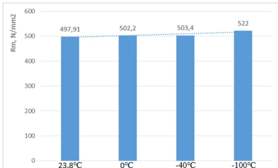
**Slika 5.1. Histogram vlačne čvrstoće mekog čelika**
