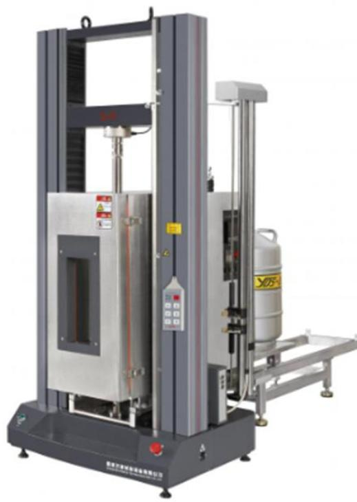
**Slika 3.2. Komora za ohlađivanje montirana na kidalicu**
