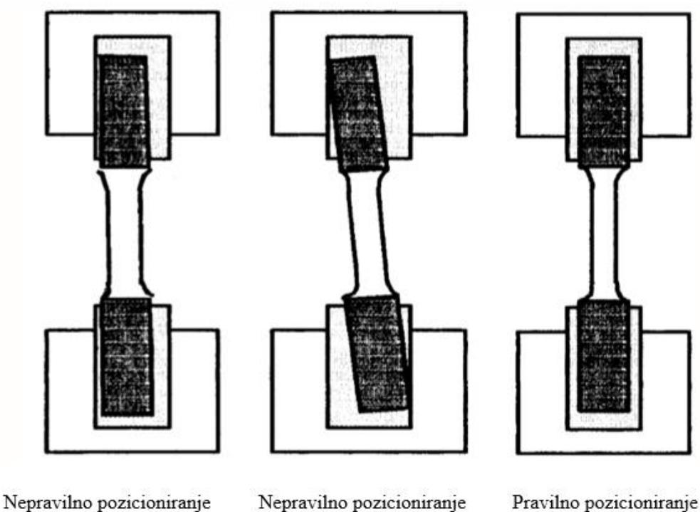
Slika 2.11. Nepravilno i pravilno pozicioniranje epruvete [2]
