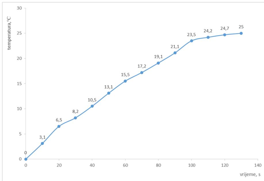
Slika 4.9. Dijagram porasta temperature mekog čelika sa 0 °C
