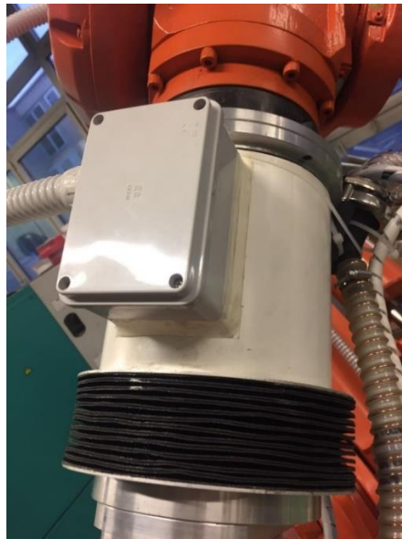
Slika 16. Posmični prigon s mogućnošću adaptivne regulacije aksijalne sile
