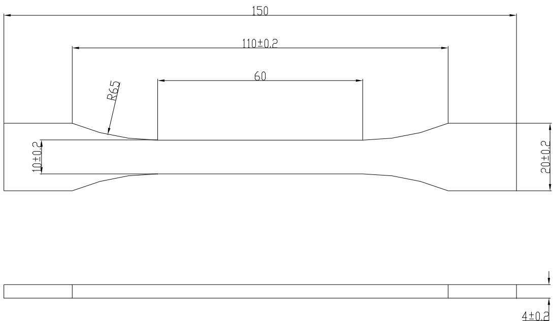
Slika 3.5. Konačne dimenzije epruvete
