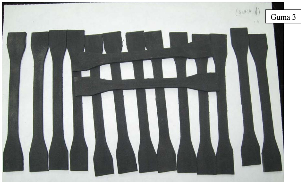
Slika 4.3. Pripremljene epruvete
