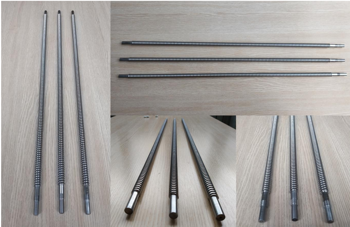
Slika 38. Izrađene pozicije kugličnog navojnog vretena
