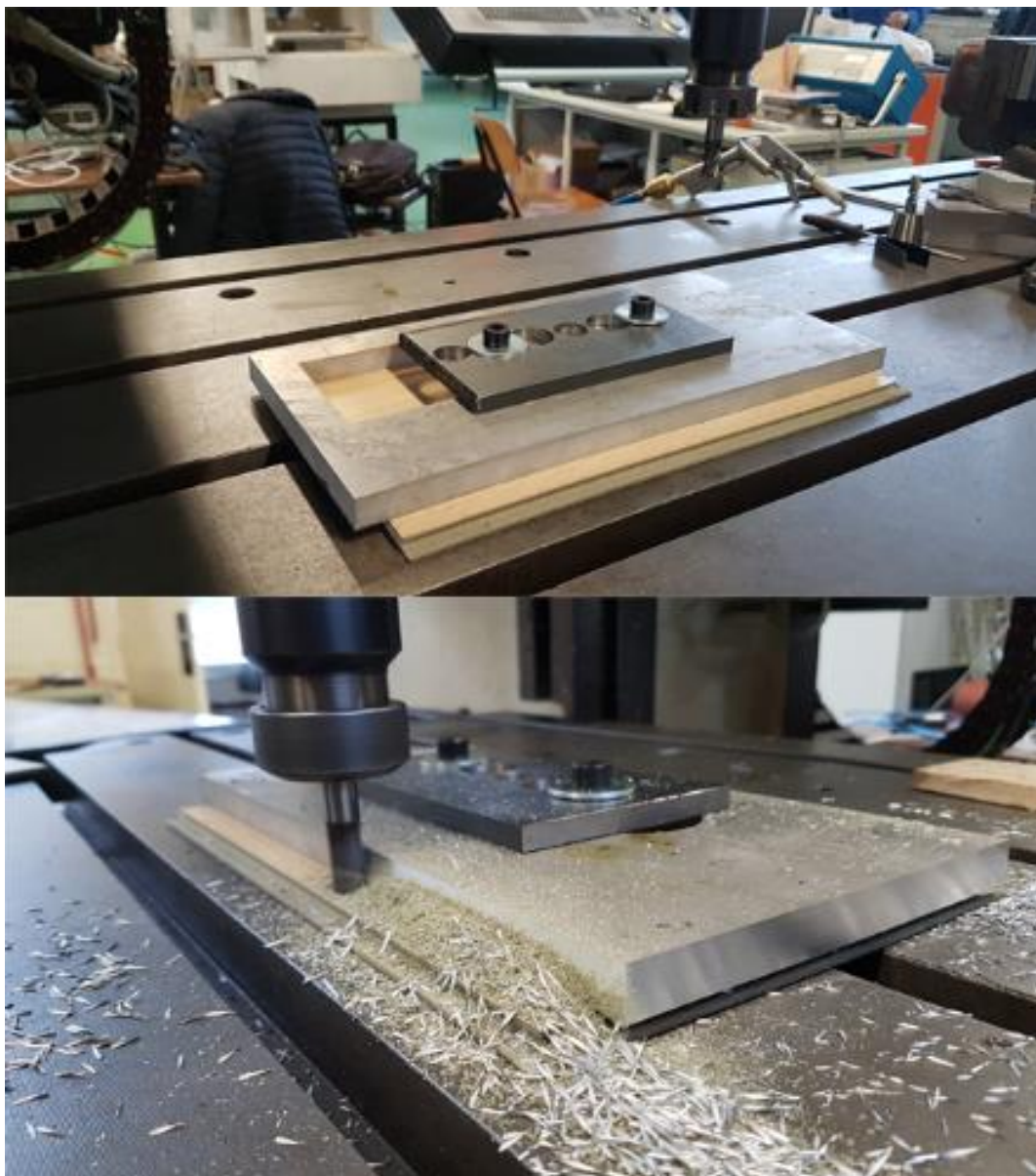
Slika 20. Obrada prednje ploče vodilice u prvom stezanju
