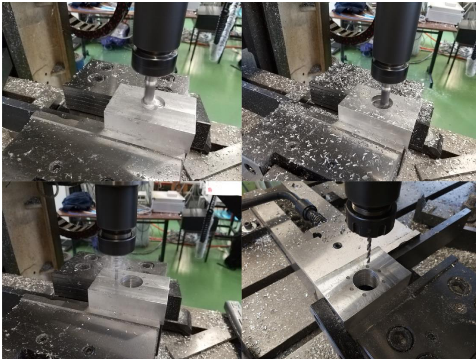
Slika 49. Izrada kućišta matice
