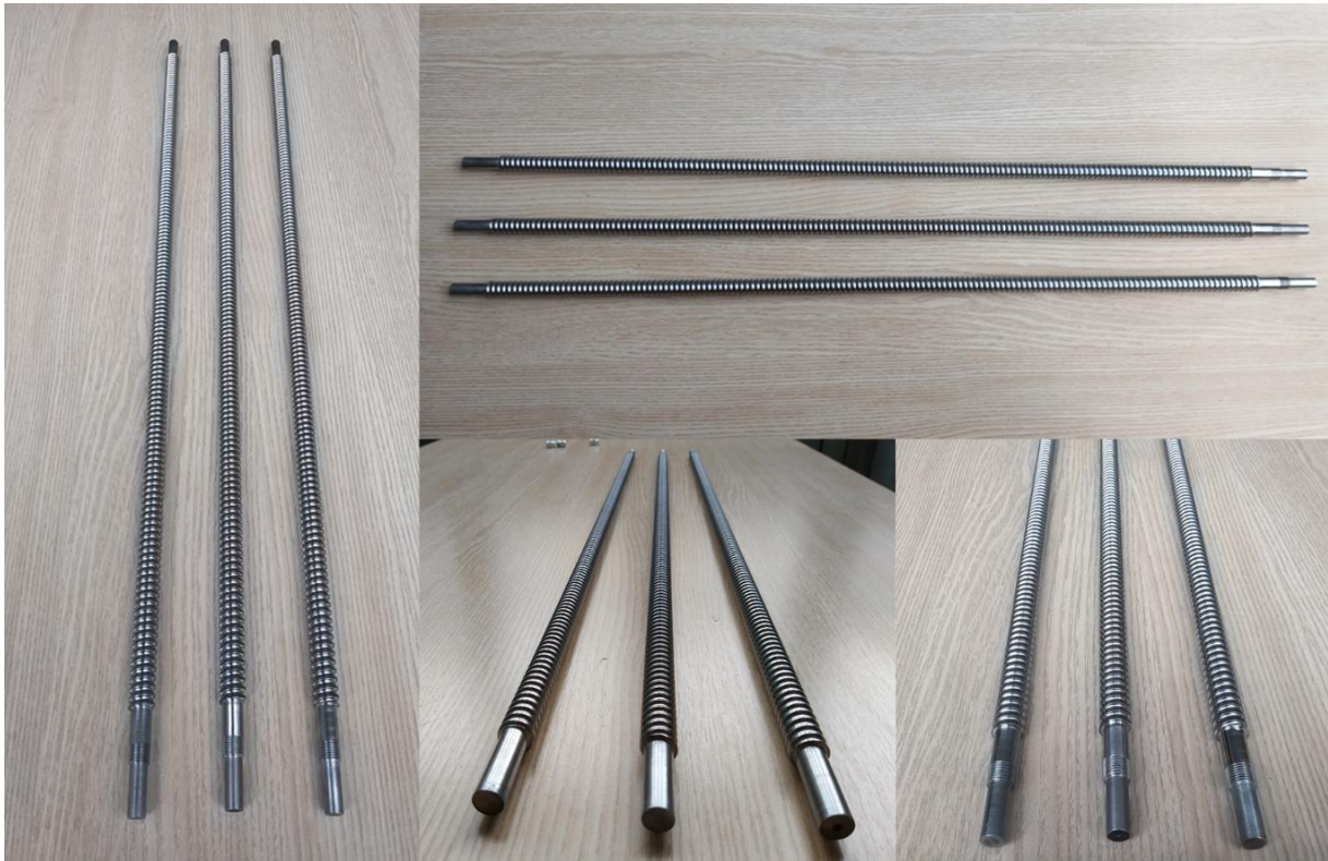
Slika 38. Izrađene pozicije kugličnog navojnog vretena
