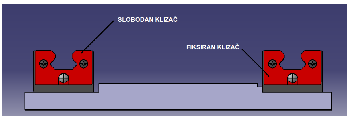
Slika 46. CAD model klizne platforme
