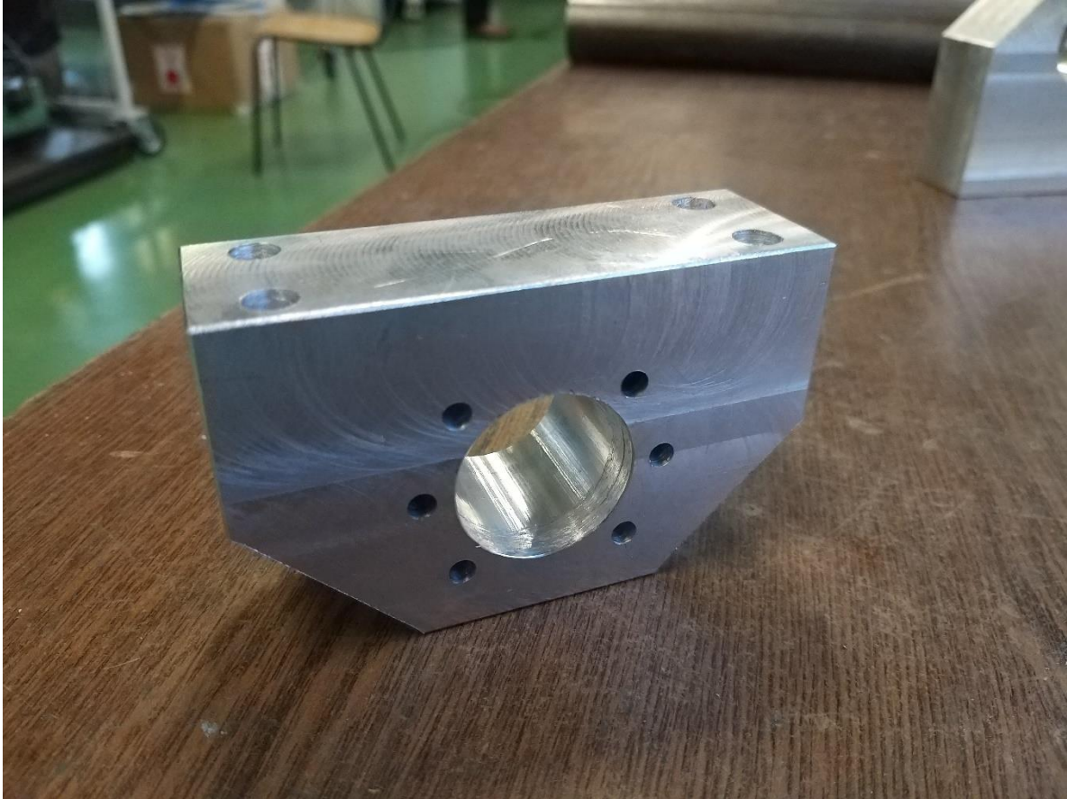
Slika 50. Izrađena pozicija kućišta matice
