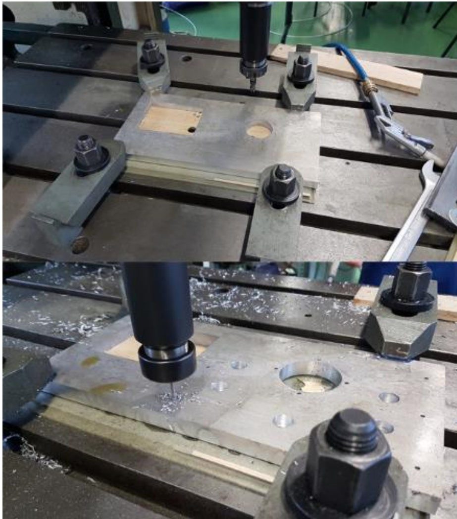
Slika 21. Obrada prednje ploče vodilice u drugom stezanju
