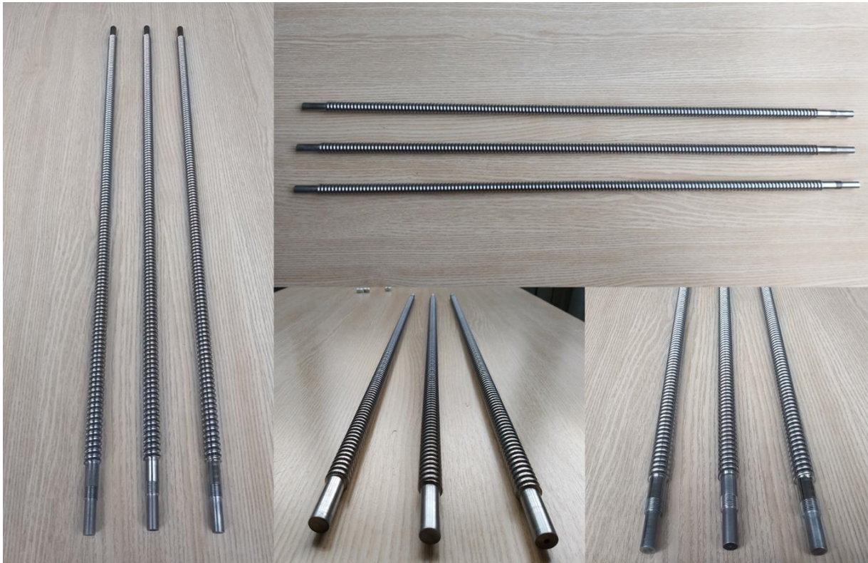
Slika 38. Izrađene pozicije kugličnog navojnog vretena
