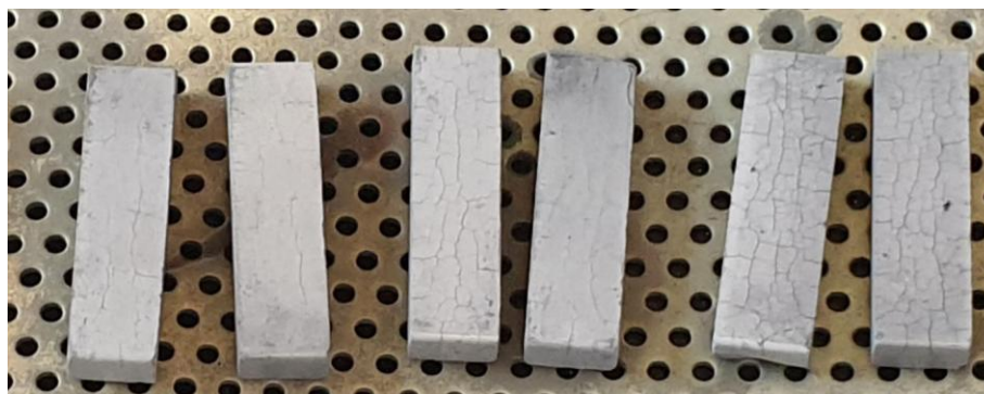
Slika 10. Pukotine na uzorcima
