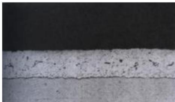
Slika 11. Mikrografski prikaz kontinuiranih trakastih linija [1]
