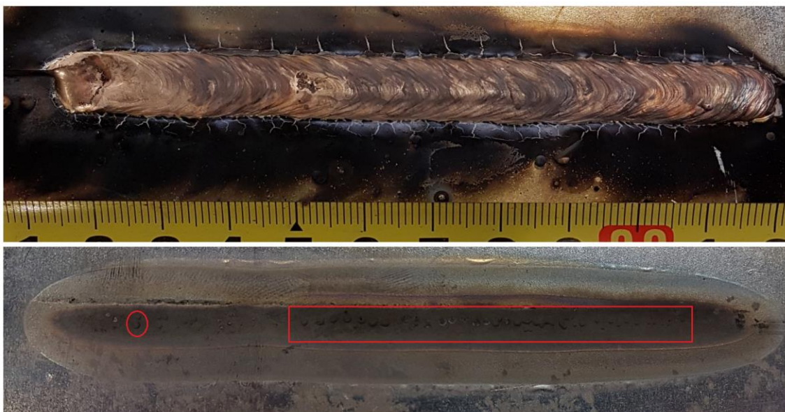
Slika 32. Uzorak 2B: - gornja slika: lice zalemljenog spoja - donja slika: naličje zalemljenog spoja
