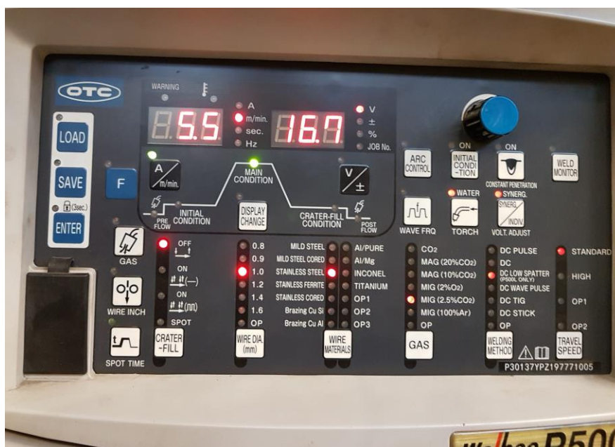
Slika 25. Sučelje za podešavanje načina rada i parametara lemljenja
