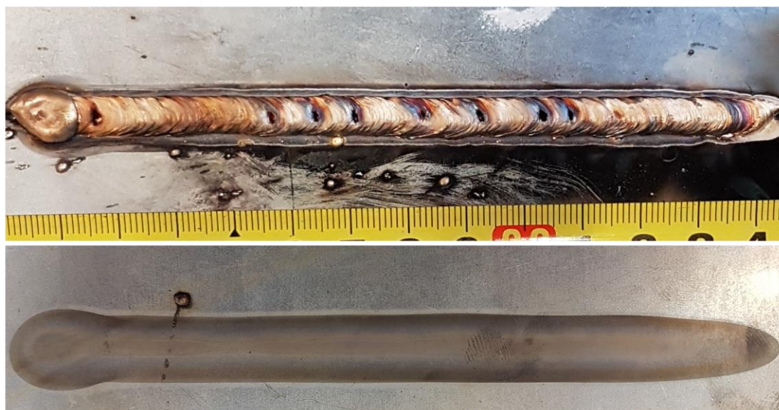
Slika 29. Uzorak 3A: - gornja slika: lice zalemljenog spoja - donja slika: naličje zalemljenog spoja
