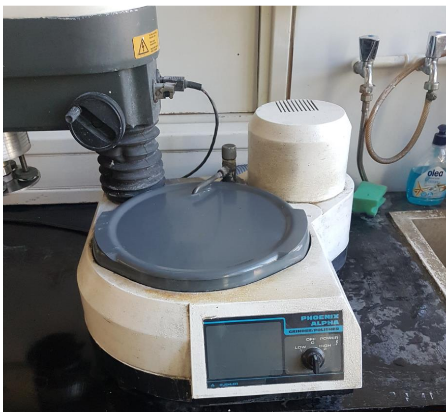
Slika 39. Stroj za poliranje uzoraka
