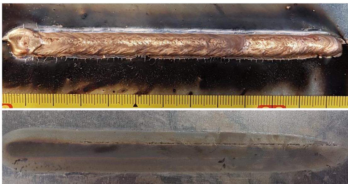
Slika 31. Uzorak 1B: - gornja slika: lice zalemljenog spoja - donja slika: naličje zalemljenog spoja
