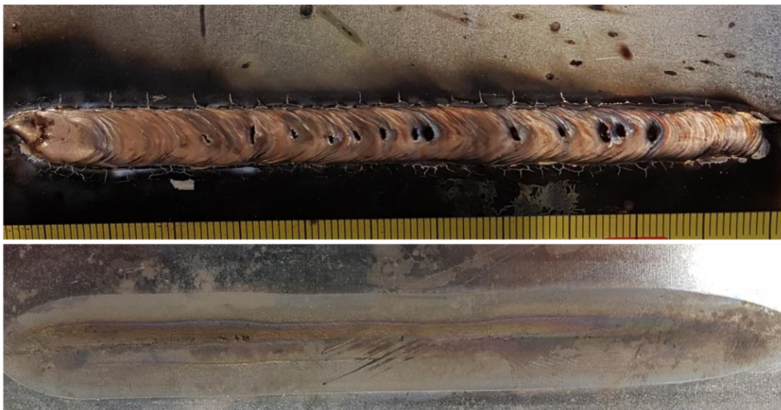
Slika 34. Uzorak 4B: - gornja slika: lice lemljenog spoja - donja slika: naličje lemljenog spoja
