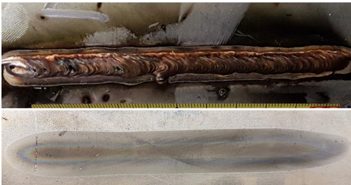
Slika 36. Uzorak 2C: - gornja slika: lice zalemljenog spoja - donja slika: naličje zalemljenog spoja
