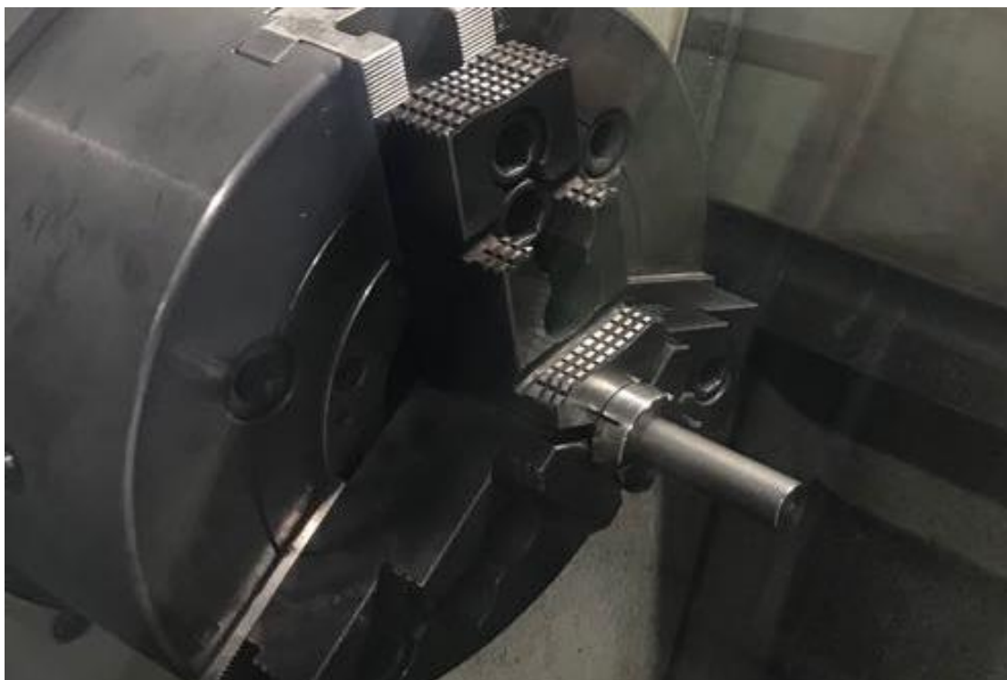
Slika 24. Čelična šipka stegnuta u amerikaner
