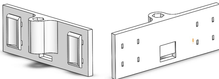
Slika 30. Nosač senzora
