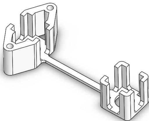
Slika 31. Nosač motora
