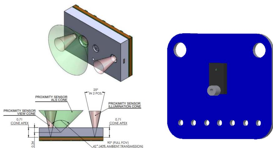
Slika 13. Prikaz vidnog područja senzora i dodanog cilindra
