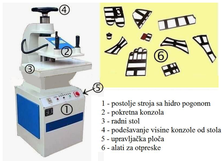
Slika 5. Preša za štancanje kože [8]
