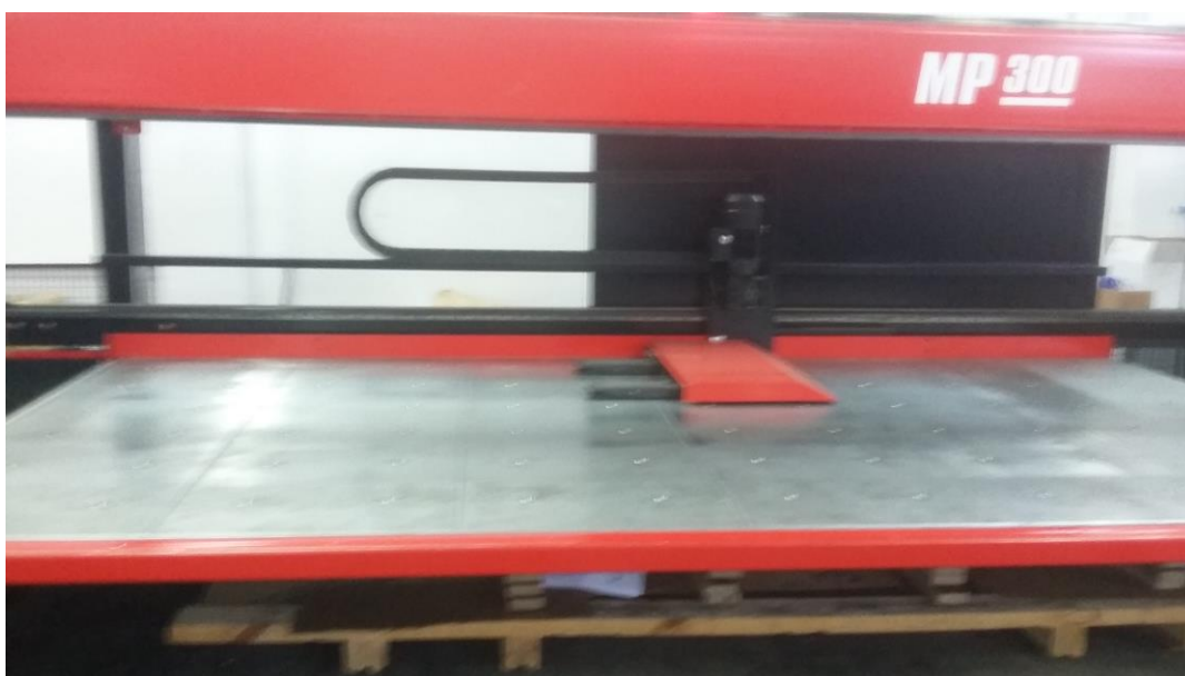
Slika 63. Graničnici prilikom stezanja limova
