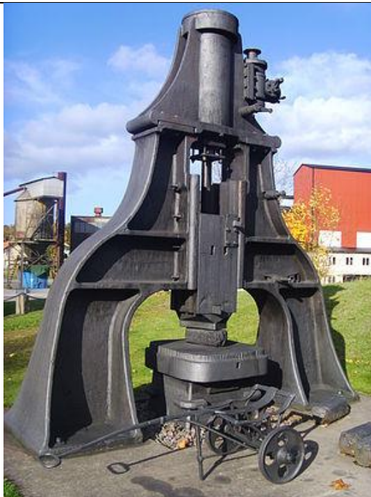
Slika 3. Stari parni bat koji je služio za proces kovanja [5]
