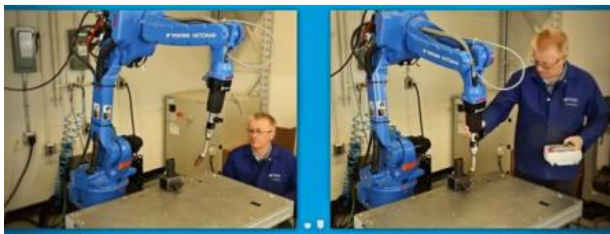
Slika 12. On-line programiranje robota [9]
