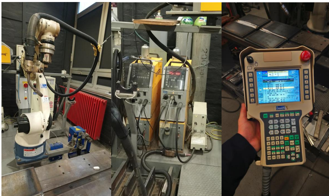
Slika 22. Robot OTC Almega AX V6, izvori struje za zavarivanje i „through arc“ senzor, „teach pendant“
