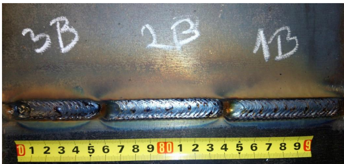
Slika 39. Zavari na uzorku B, utjecaj parametra brzine korekcije
