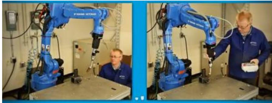
**Slika 12. On-line programiranje robota [9]**
