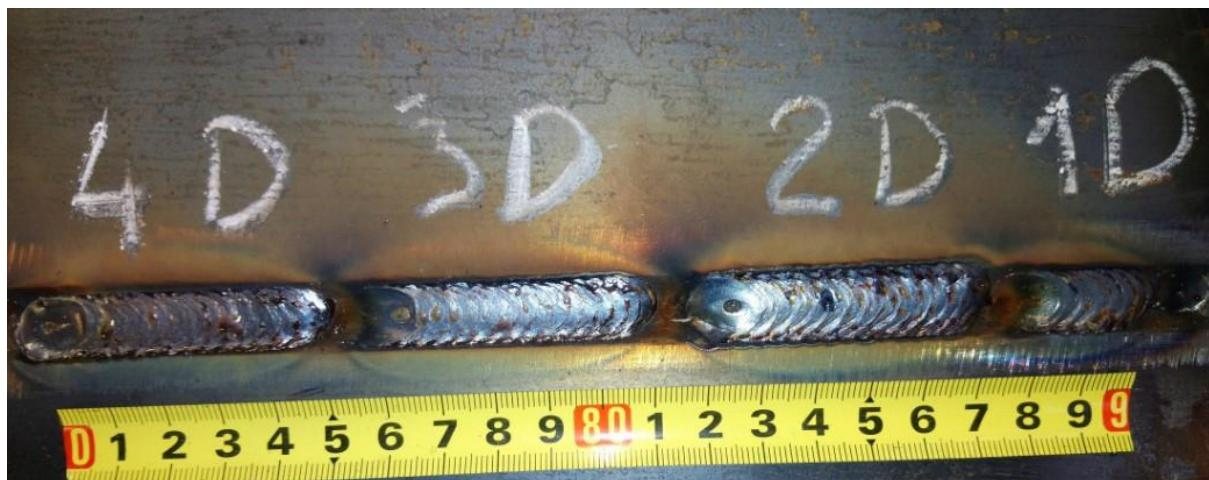
**Slika 41. Zavari na uzorku D, 1D kružno njihanje; 2D, 3D, 4D utjecaj parametra odstupanja pištolja („Offset“) i veličine amplitude njihana**
