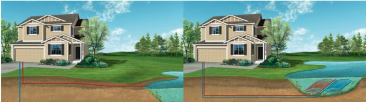
Slika 2.2 Otvorena (lijevo) i zatvorena (desno) izvedba sustava dizalice topline morska voda - voda [11]
